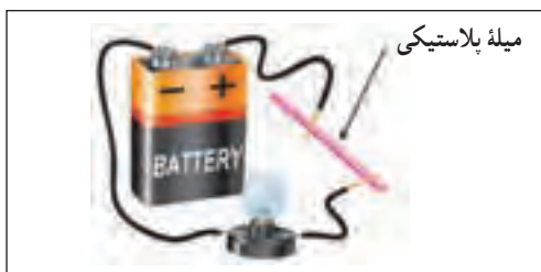
▲ شکل ۱-۱۰- میله پلاستیکی عایق است
