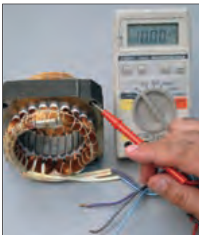
▲ شکل ۱۴-۲- تست اتصال بدنه
