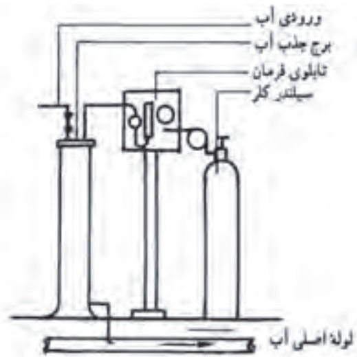
▲ شکل ۴-۶ نمای ساده دستگاه کلرزنی
