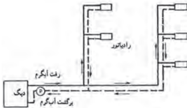
▲ شکل ۹-۳- حرارت مرکزی با آب گرم
