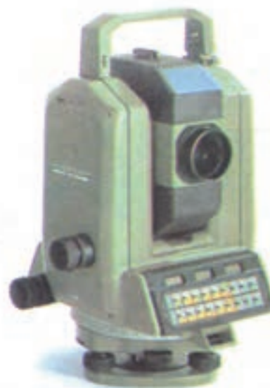
شکل ۲۴-۴ فاصله‌یاب در داخل دوربین نقشه‌برداری
