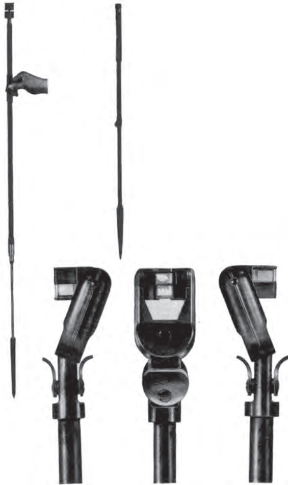
شکل ۸-۳- گونیای منشوری و پایه‌ی مخصوص آن
