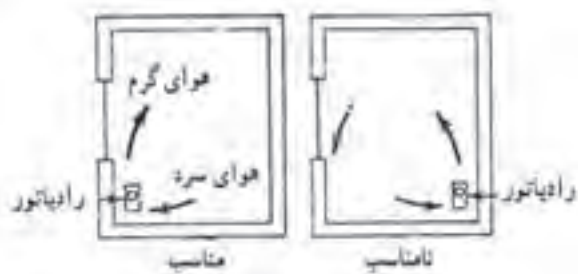
ج) مقایسه محل نصب رادیاتور در یک اتاق
