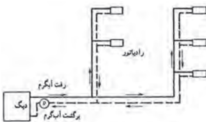
▲ شکل ۳-۹- حرارت مرکزی با آب گرم
