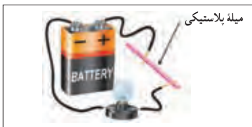
▲ شکل ۱۰-۱- میله پلاستیکی عایق است
