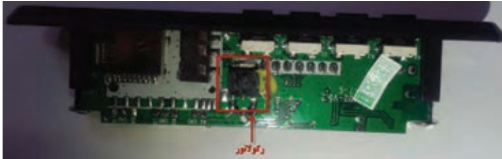
شکل ۵-۸- برد MP۳ با رگولاتور ۷۸۰۵ داخلی
