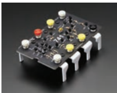
شکل ۴-۵۴- مدار داخلی آی سی ۷۴۱ با قطعات مجزا
