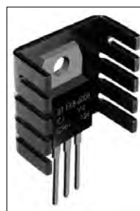
شکل ۷-۶۸ ترایاک متصل شده به گرماگیر
