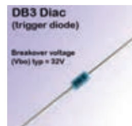
شکل ۷-۴۱ بخشی از برگه اطلاعات یک نوع دیاک
