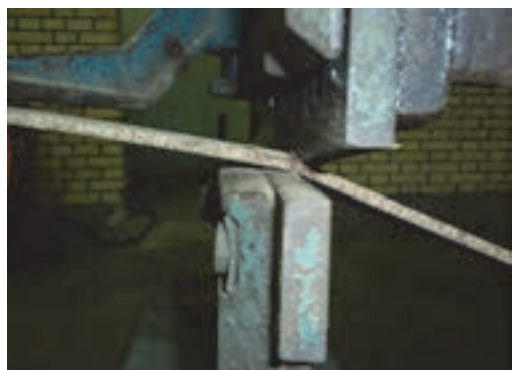
شکل ۲۹- نفوذ تیغه‌ها در قطعه
