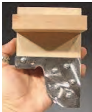
شکل ۱۸- شابلون تقویت شده با چوب
