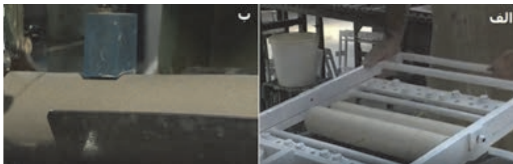
شکل ۳۶- برش گل و ساخت دیسک: (الف) دستی (ب) ماشینی
