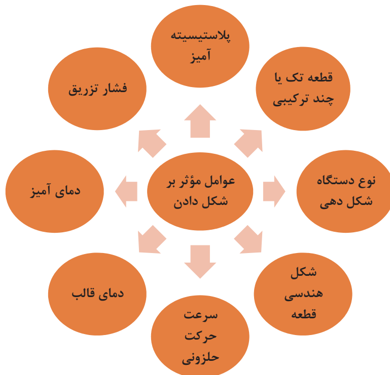
شکل ۲۹- عوامل مؤثر بر شکل دهی در روش قالبگیری تزریقی
