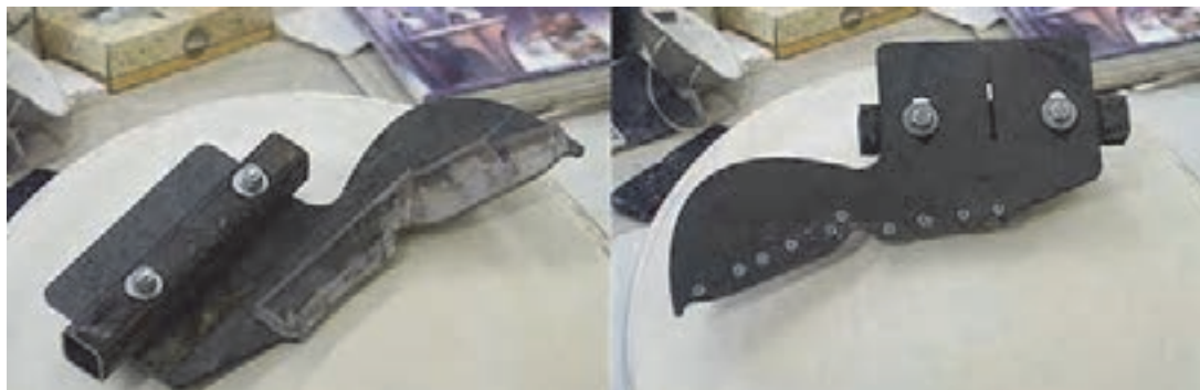
شکل ۲۰- شابلون با پیچ و مهره قابل تنظیم
