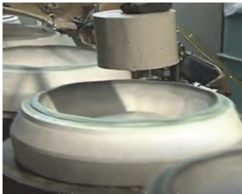
شکل ۳۸- قرار دادن دیسک گل در قالب
