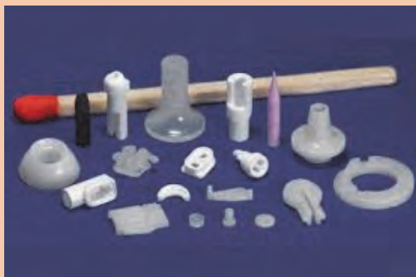
شکل ۱۳- میکروسازه‌های سرامیکی تولیدشده به روش قالبگیری تزریقی
