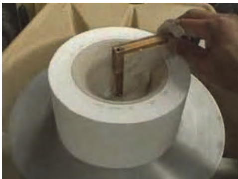
شکل ۳۹- پایین آوردن بازوی جولی و شکل‌دهی
