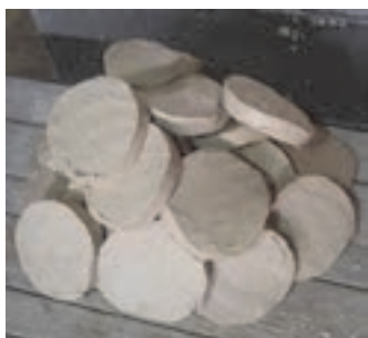
شکل ۳۰- آماده کردن گل به صورت ورقه‌ای
