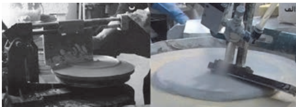
شکل ۳۲- الف) پهن کردن گل، ب) شکل دادن
