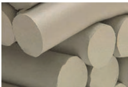
شکل ۸- اکستروود کردن گل پلاستیک
