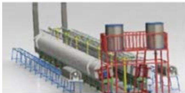
ب) قرار دادن مخزن دوغاب در ارتفاع
