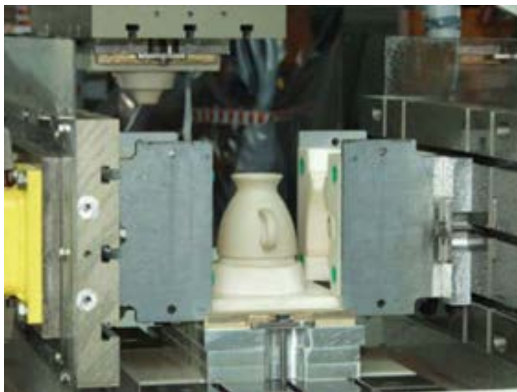
شکل ۹- شکل دهی بدنه در قالب رزینی
