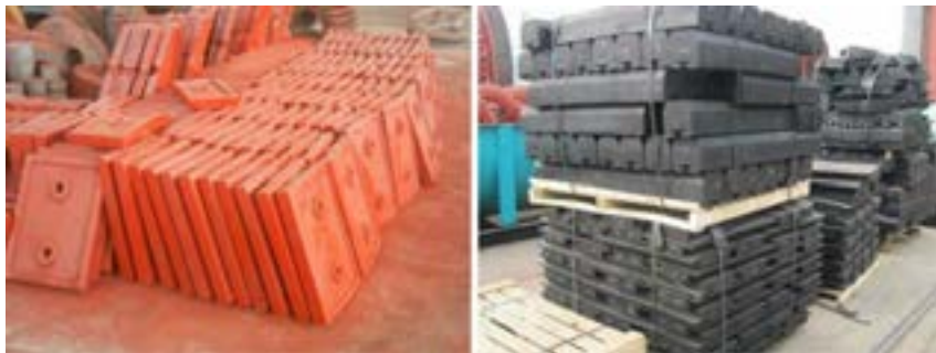
شکل ۲۱- آستر لاستیکی بال میل
