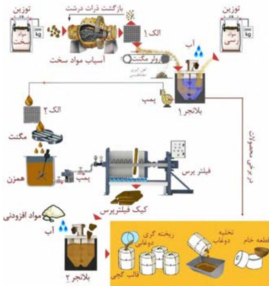
شکل ۱۱- فرایند ساخت دوغاب و شکل‌دهی قطعه
