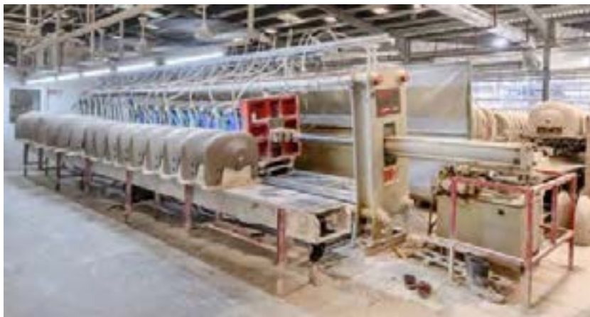
شکل ۶- ریخته‌گری دوغابی با فشار پایین
