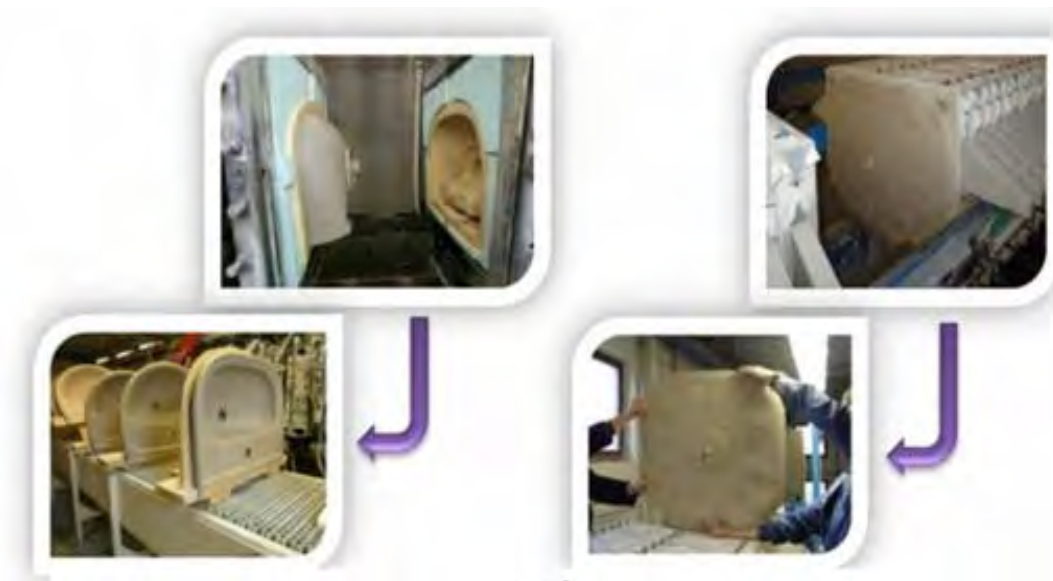
شکل ۵- الف) فیلتر پرس ب) ریخته‌گری دوغابی تحت فشار
