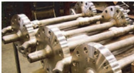
شکل ۳۴- لنس‌های متصل به لوله‌های اسپری درایر
