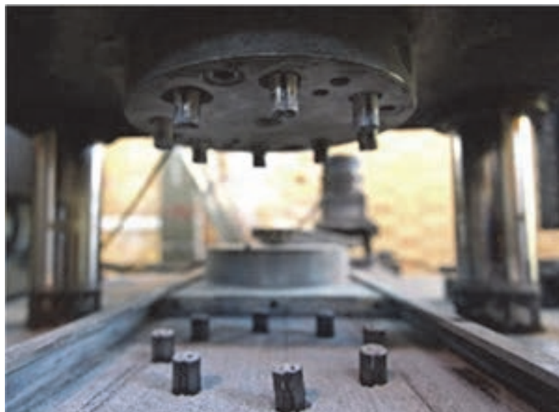
شکل ۱۱- پرس با قالب حاوی ۸ حفره
