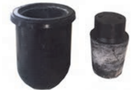
شکل ۱۴- قالب و پانچ پلی یورتانی جهت تولید گلوله
