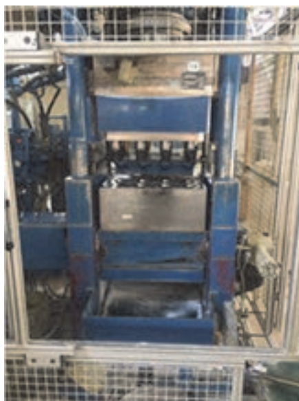
شکل ۱۳- پرس ایزواستاتیک گلوله آلومینایی
