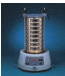
ب) الک‌ها روی دستگاه لرزاننده
