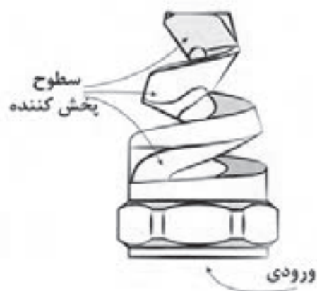
شکل ۲۴- افشانک نازلی نوع حلزونی
