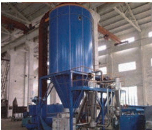
شکل ۲۸- محفظه خشک کن اسپری درایر صنعتی
