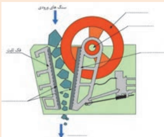
شکل ۱۹- اجزای سنگ شکن فکی
