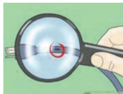
الف) پارگی پوشش سیم تغذیه
