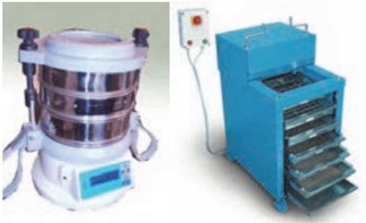
شکل ۱۰- دستگاه لرزاننده در اشکال و ابعاد مختلف
