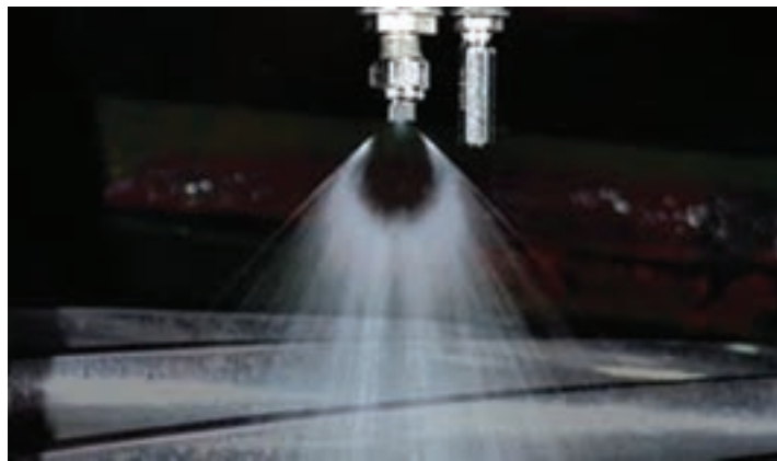
شکل ۲۰- روغن کاری پاششی
