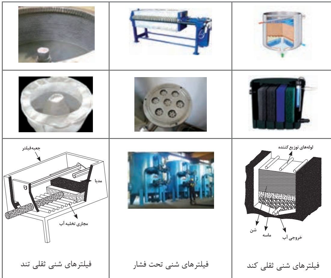
شکل ۱۵- انواع فیلترهای ثقیلی، تحت فشار، گریز از مرکز سانتریفیوژ، بیوفیلتر و غشایی
