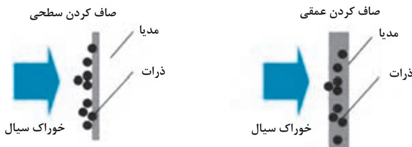
شکل ۶- انواع فیلتراسیون (بر حسب چگونگی حرکت سیال)
