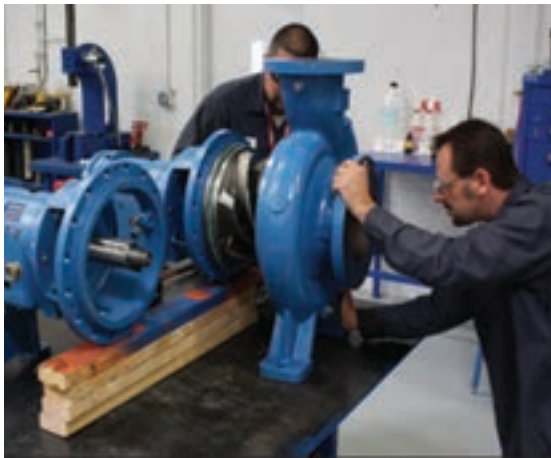
شکل ۲- تعمیر اساسی پمپ در کارگاه مکانیک
