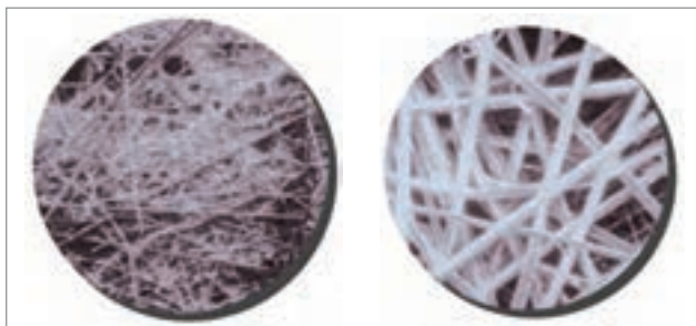
شکل ۴- تصویر میکروسکوپی دو نمونه از فایبرگلاس مورد استفاده در صافی‌ها
