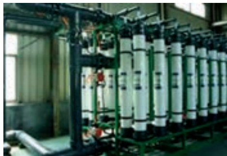
شکل ۱۰- نمایی ساده و واقعی از فرایند اولترافیلتراسیون
