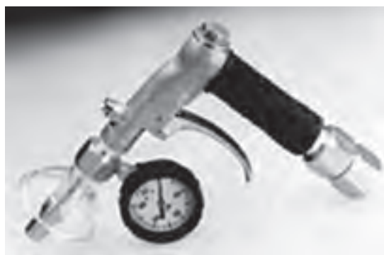
شکل ۱۹- نمونه‌هایی از دستگاه‌های تزریق کننده آب پر فشار
