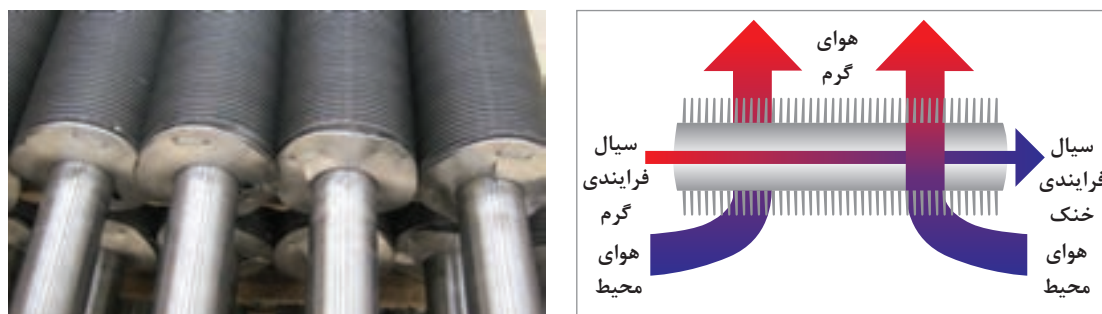
شکل ۲۶- لوله‌های پره‌دار در خنک‌کننده‌های هوایی
