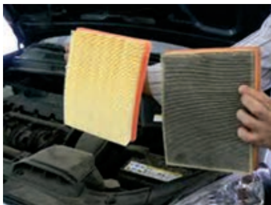
شکل ۲۲ - فیلتر هوای تمیز و کار کرده
