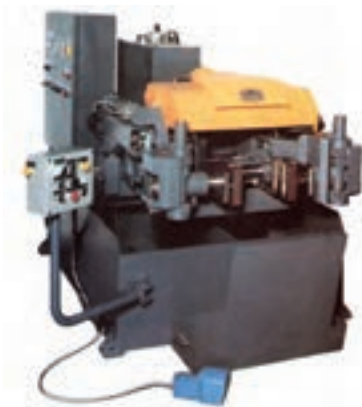
شکل ۳-۲۱- ماشین ریخته گری ریژه تمام اتوماتیک
