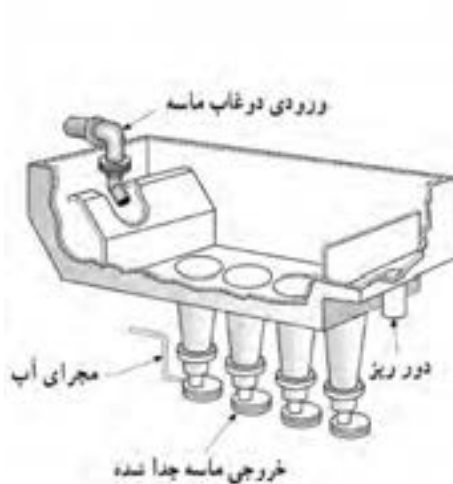
شکل ۳-۳۷- سیستم جداکننده هیدرولیکی در احیای ماسه به روش تر
