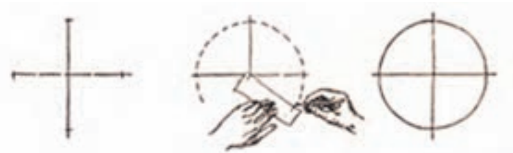
۲. به کمک نشانه‌گذاری روی قطرها (شکل ۳-۱۴). شکل ۳-۱۴
