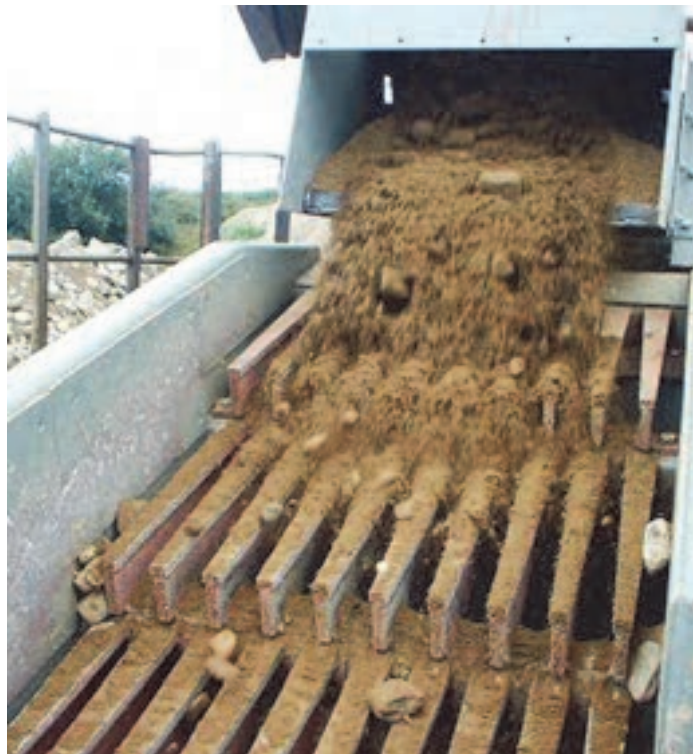
فیدر (تغذیه‌کننده) و سرند گریزلی سنگ‌شکن فکی
