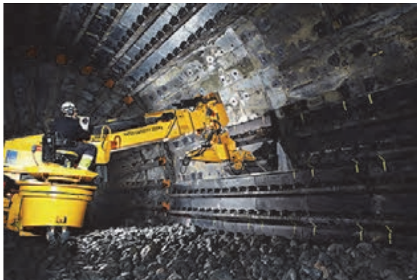
نحوه تعویض آسترهای دستگاه آسیا
