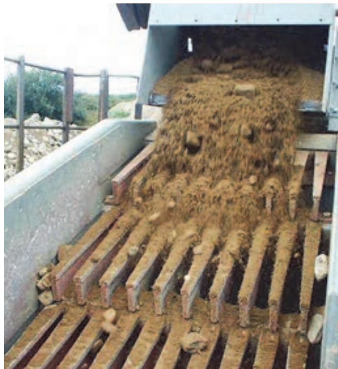
فیدر (تغذیه‌کننده) و سرند گریزلی سنگ‌شکن فکی
