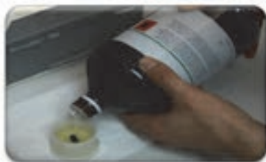
۵- قرار دادن نمونه در رزین
