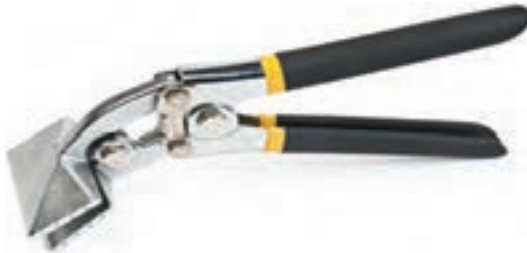
شکل ۱۹- خم کاری ورق با انبر قفلی
