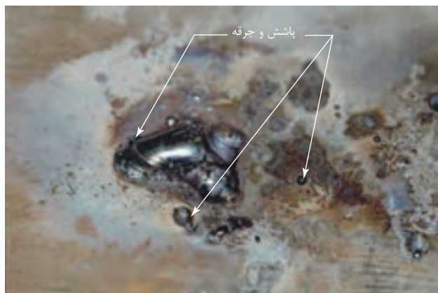
شکل ۴-۳۶: پاشش سخت شده بر روی فلز پایه
