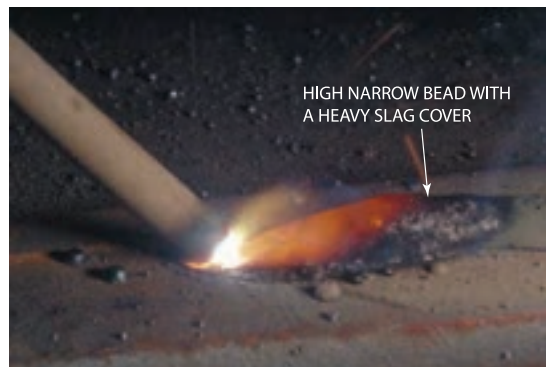
شکل ۴-۳۸: جوشکاری با طول قوس بسیار کم
