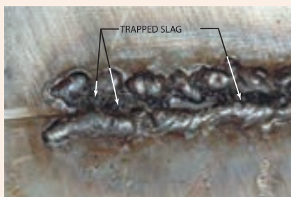
شکل ۴-۶: عیب ایجاد شده در اثر حرکت سریع الکتروود در عرض جوش
