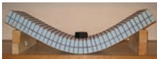
شکل ۳- تغییر شکل ورق بعد از خم کاری
