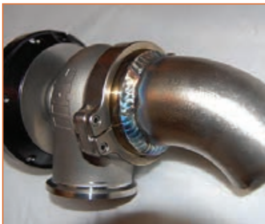
الف - جوش کاری دو قطعه فولادی
