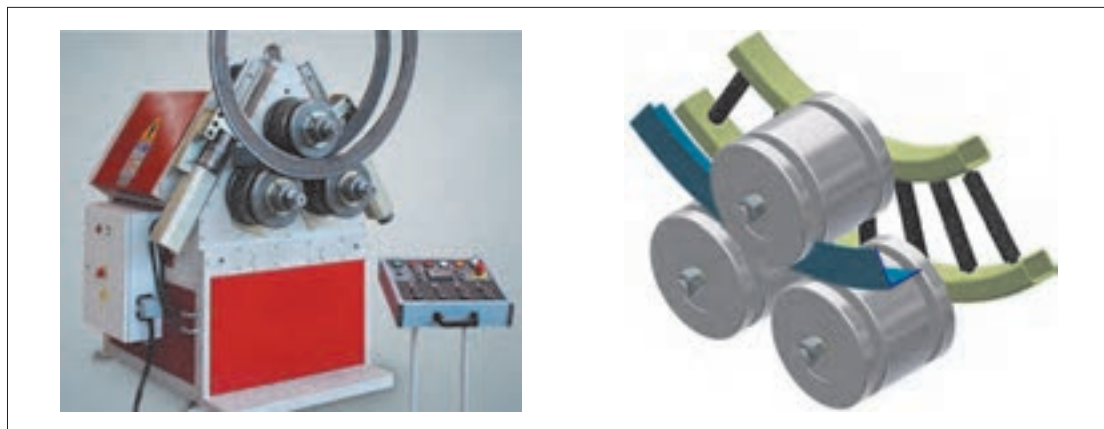
شکل ۳-۱۷- دستگاه خم کن سه غلتکی افقی
