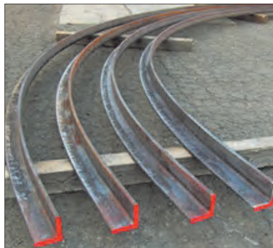
شکل ۳-۲۱- پروفیل با شعاع خم متفاوت
