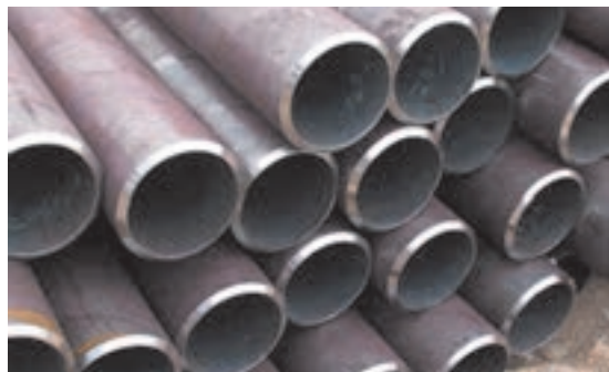
شکل ۳-۲ - لوله بدون درز
