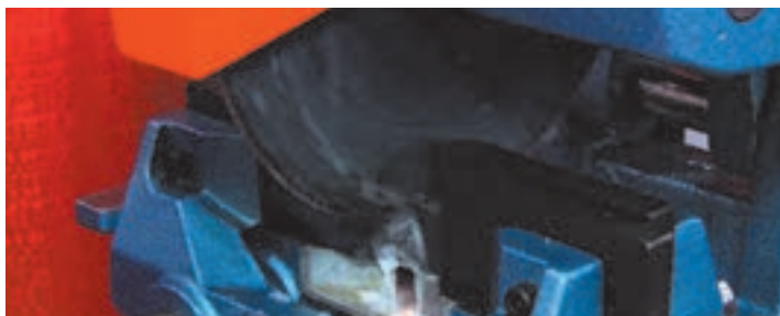
شکل ۱-۱۹- برشکاری با اره آب صابونی
