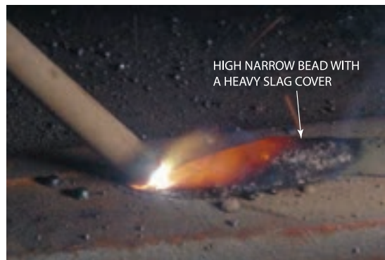
شکل ۴-۳۸: جوشکاری با طول قوس بسیار کم
