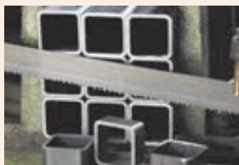
شکل ۱-۱۸- سری بری با استفاده از ااره لنگ
