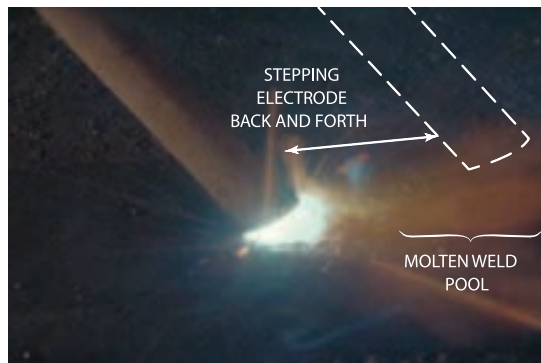
شکل ۴-۵۳: الکتروده به آرامی به سمت جلو می‌رود و دوباره به حوضچه جوش بر می‌گردد
