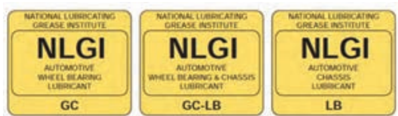
شکل ۱۱- برخی نمادهای گریس مورد استفاده در خودرو
