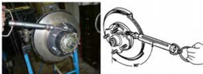
شکل ۱۸- بررسی توپی و بلبرینگ یا رولبرینگ
