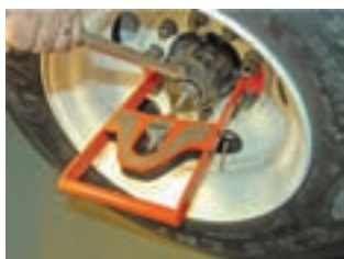
شکل ۲۱- روش تنظیم پیش‌بار بلبرینگ یا رولبرینگ
