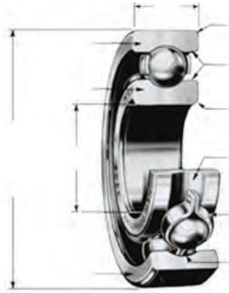
شکل ۵- ساختمان و اجزای بلبرینگ
