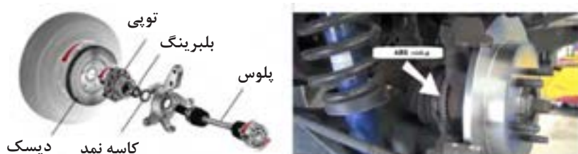
شکل ۱۹- حسگر ABS روی چرخ
