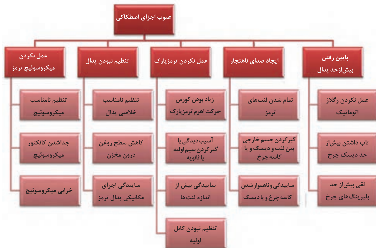
شکل ۲۳- عیوب اجزای اصطکاکی
