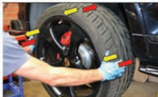
روش کنترل لقی اتصالات اهرم بندی و یا خلاصی فرمان
