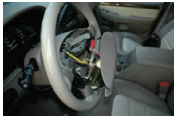
باز کردن تجهیزات جانبی از روی غربیلک فرمان
