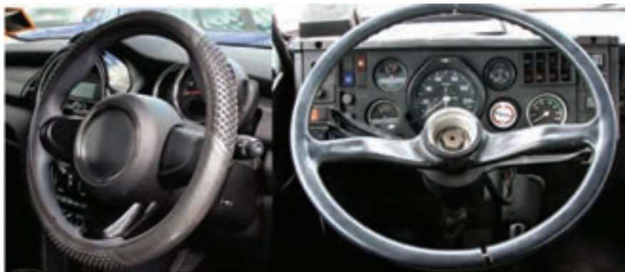
شکل ۴ - انواع غریبک فرمان در خودرو سواری و سنگین
