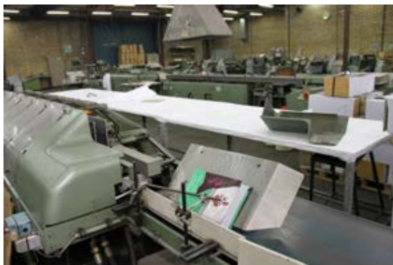
شکل ۶۴- قسمت تحویل دستگاه جلدگذاری
