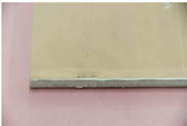
شکل ۱۶- رعایت فاصله مناسب مفتول تا انتهای عطف
