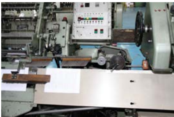
شکل ۲۵- شانه سرعت گیر
