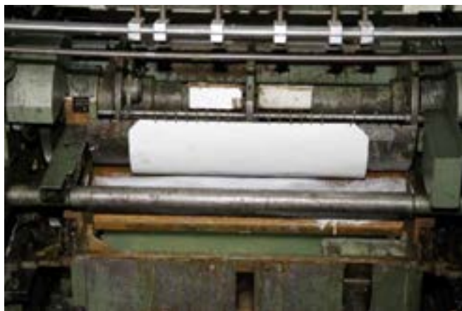
شکل ۴۸- آغشته شدن پوشش به چسب
