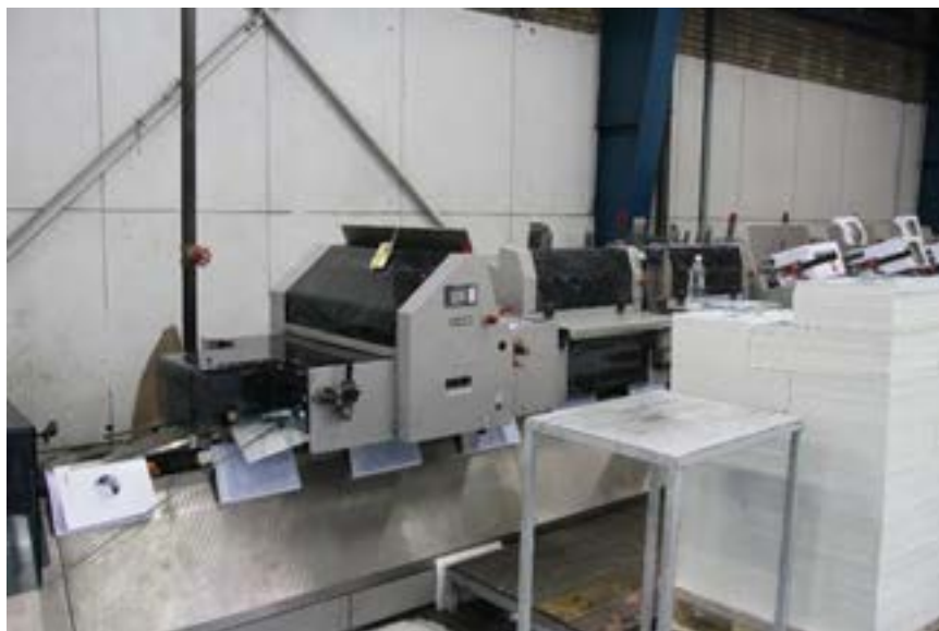
شکل ۴۰- ماشین‌های مفتول‌زنی اتومات
