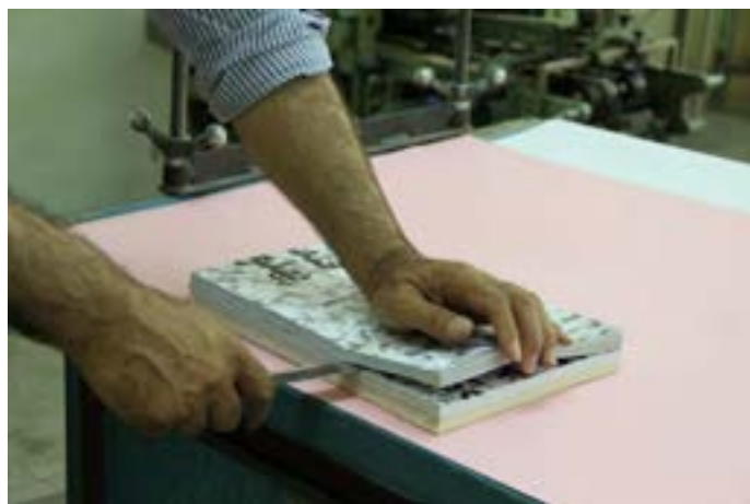
شکل ۱۴- جدا کردن بلوک‌ها از یکدیگر
