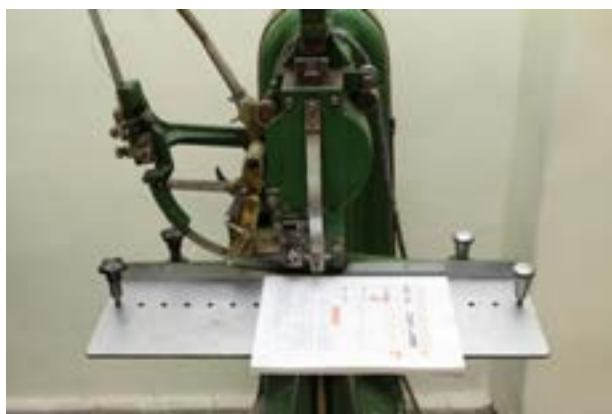
شکل ۱۱- بلوک مفتول دوزی شده از بغل
