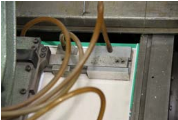
شکل ۵۲- پرس جلد و برگرداندن لبه‌های کالینکو
