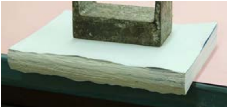
شکل ۴- غیر یکنواخت شدن چسب در عطف کتاب
