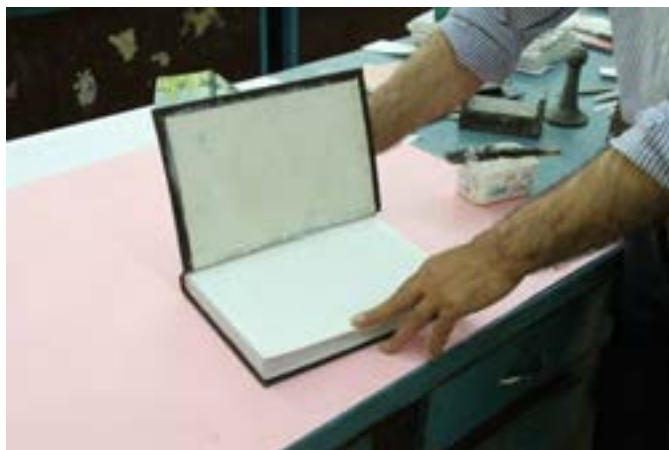
شکل ۵۶- تلفیق جلد و بلوک
