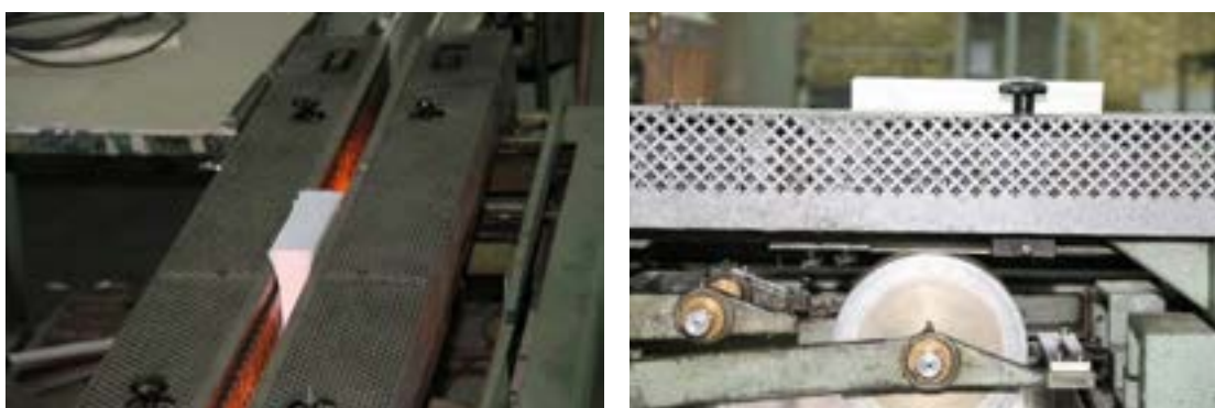
شکل ۳۲- دستگاه ته‌چسب بلوک‌های دوخته شده و خشک‌کن چسب عطف
