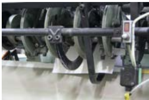
شکل ۲۳- چنگک‌های بلند، فوتک‌ها و بازکننده‌ها و طرز کار آنها
