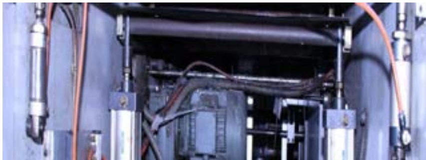
شکل ۳۸- جک های هیدرولیک سیلندر ضربه زننده
