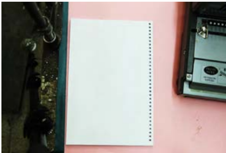
شکل ۶۵- فاصله شروع پانچ تا لبه فرم و فاصله اولین سوراخ پانچ با عرض فرم
