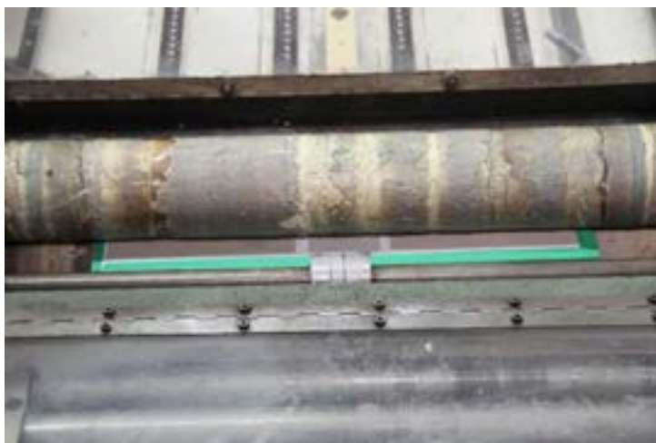
شکل ۵۳- صاف کردن پوشش‌های پرس شده
