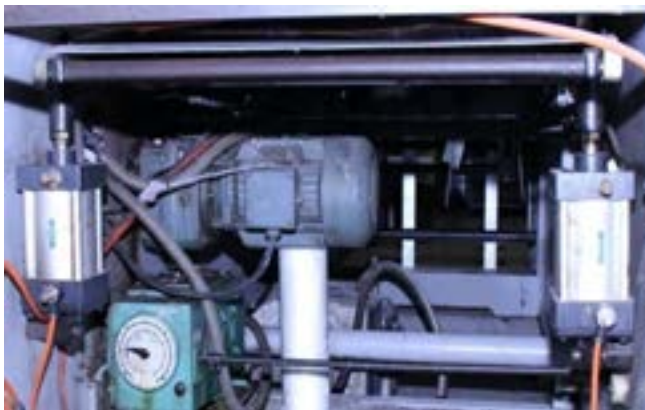
شکل ۳۴ - تنظیم فشار سیلندرها توسط جک‌های پنوماتیک
