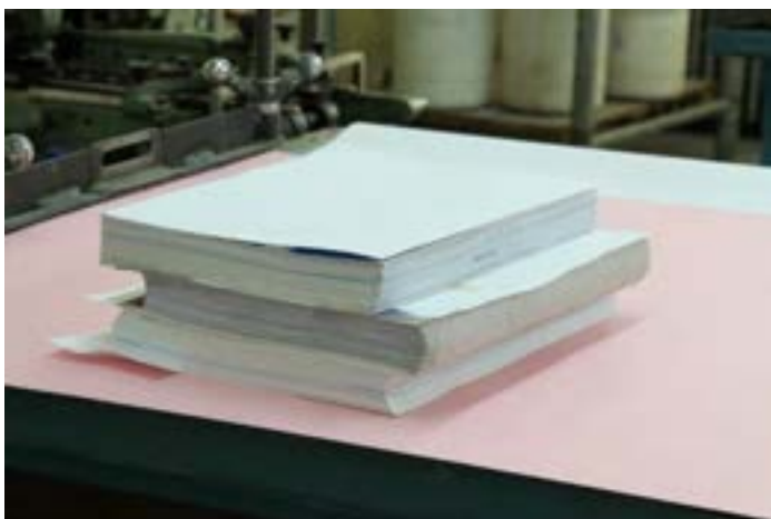
شکل ۶- قرار دادن کاغذ بر روی بلوک‌ها جهت جلوگیری از چسبیدن عطف
