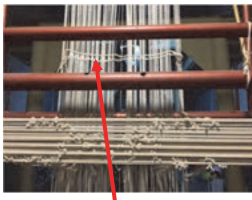
شکل ۶۴- قرار دادن نخ بچار لای چله‌ها
