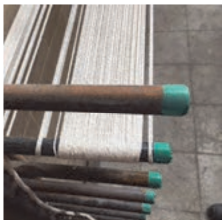
شکل ۳۳- عبوردادن نخ به صورت حلقه‌ای در سرکار شکل ۳۴- عبور دادن نخ به صورت زیگزاگ در ته کار
