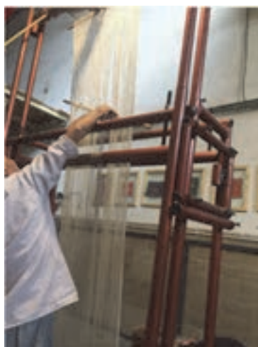
شکل 47- پایین آوردن چوب مهار و مرتب کردن تارها
