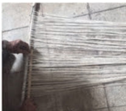
شکل ۳۷- قرار دادن چوب‌های گُرت در داخل چله
