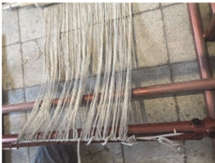
شکل ۴۲- ته دوزی کردن تارها
