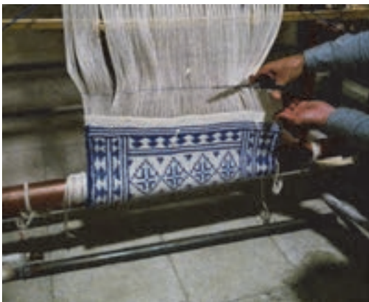
شکل ۸۳- چیدن یا برش دادن زیلو
