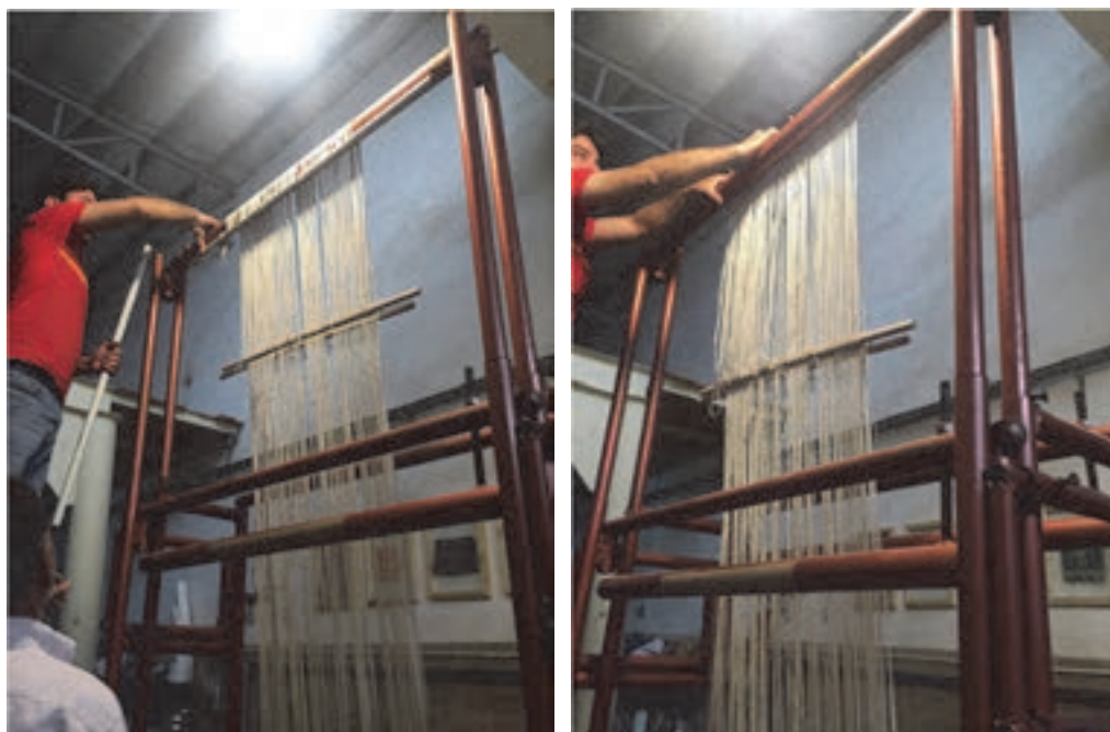
شکل ۴۳- بستن چله‌ها بر روی تیر بالا
