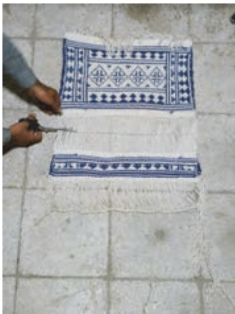
شکل ۸۷- برش دادن و جدا کردن زیلوه‌ها
