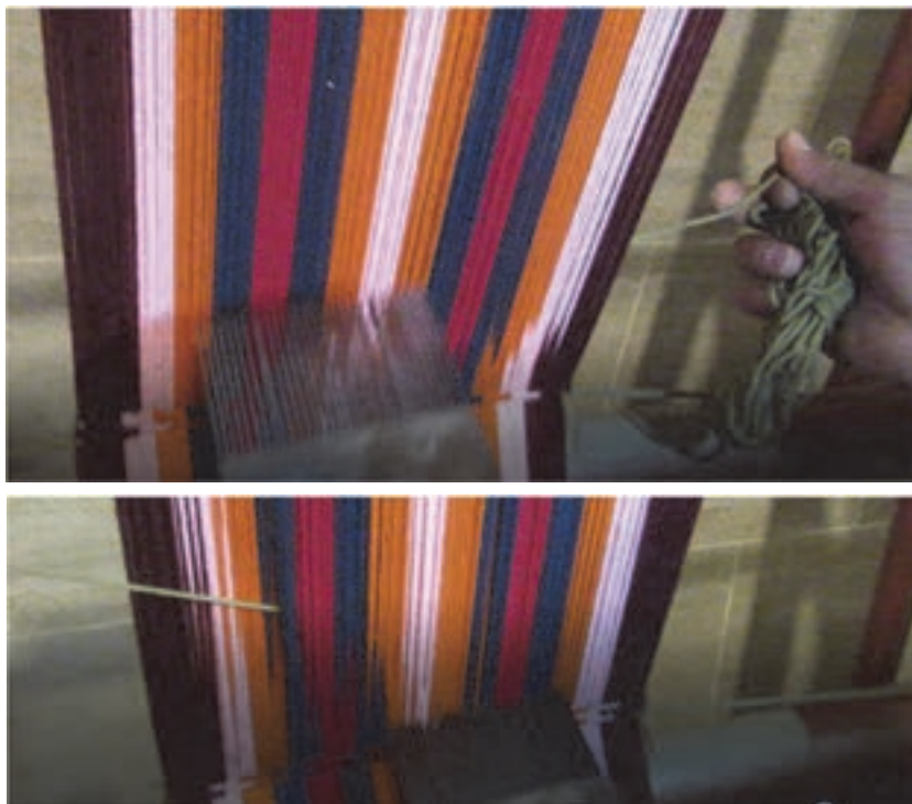
شکل ۲۲- کوبیدن پود در هنگام بافت
