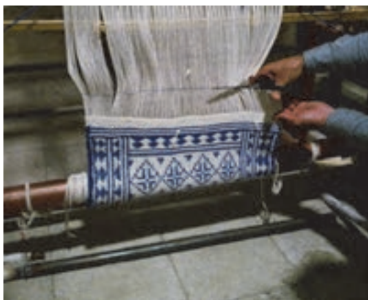
شکل ۸۳- چیدن یا برش دادن زیلو
