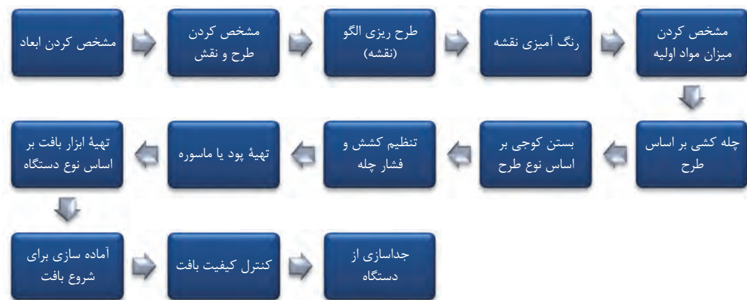
نمودار ۲-۳ مراحل شکل‌گیری جاجیم
