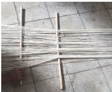
شکل ۳۷- قرار دادن چوب‌های گُرت در داخل چله
