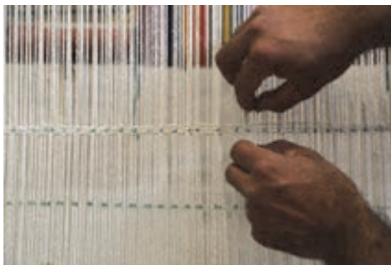
شکل ۷۲- مرتب کردن و تنظیم فاصله چله‌ها
