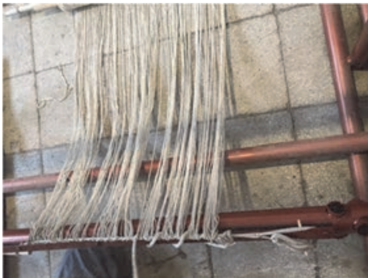
شکل ۴۲- ته دوزی کردن تارها
