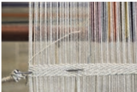
شکل ۷۳- اتمام بافت سرپر
