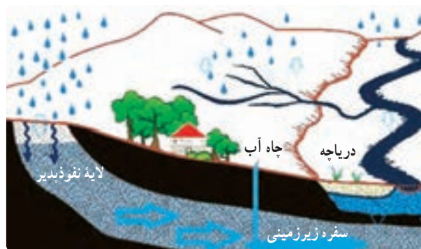
شکل ۴۴-۱- چگونگی شکل‌گیری سفره‌های آب زیرزمینی
