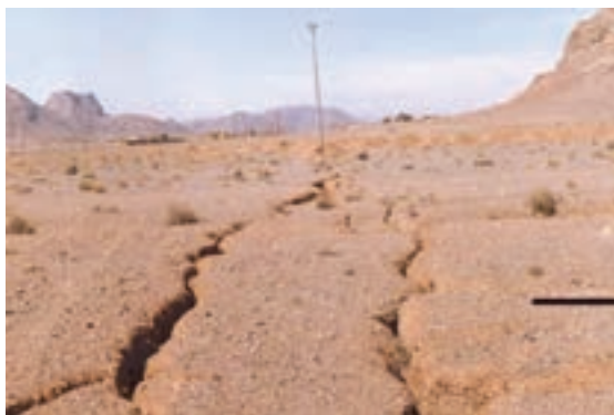
شکل ۳۲-۳- شکاف‌های ایجاد شده در اثر نشست زمین بر اثر برداشت بی‌رویه از سفره‌های آب زیرزمینی - دشت مهبیار
