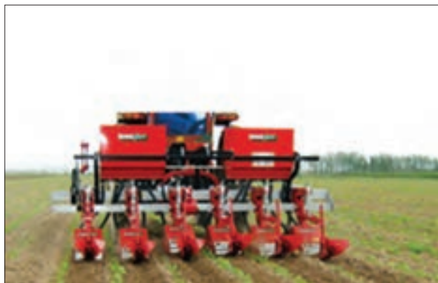
انواعی از کولتیواتورهای داشت در حال انجام عملیات مکانیزه خاک‌دهی پای بوته
