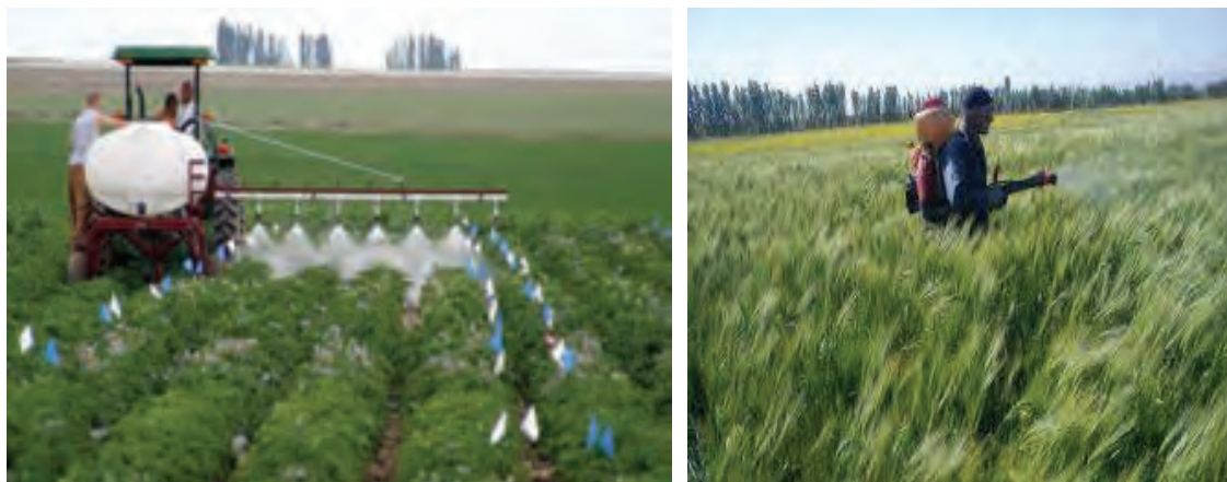
شکل ۴۲- محلول پاشی عناصر غذایی روی گیاه توسط سمپاش پستی (سمت راست) و سمپاش تراکتوری بوم‌دار (سمت چپ)
