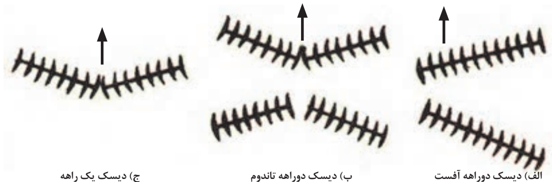
شکل ۶-۲. انواع دیسک از لحاظ آرایش گروه‌های بشقاب
