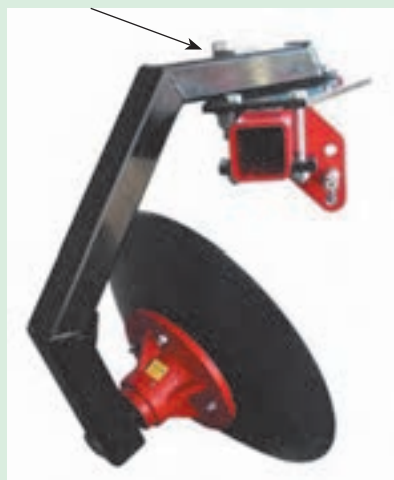
شکل ۴۱-۲. اتصال بشقاب به شاسی
