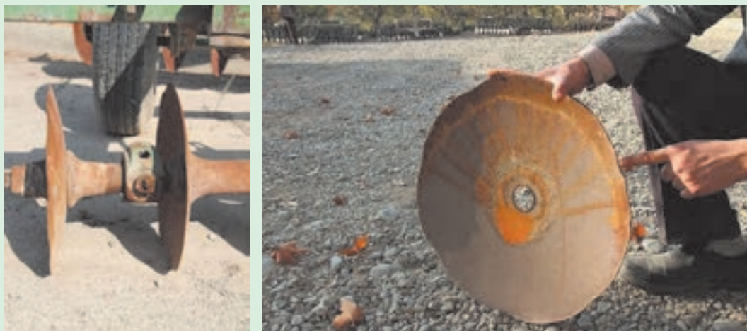
شکل ۱۵-۲. بررسی بشقاب‌ها و یاتاقان‌ها
