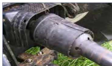
شکل ۳-۷۳- گاردان مجهز به کلاچ یک‌طرفه
