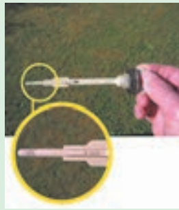
شکل ۵۷-۴. بازدید روغن موتور و شمع موتور
