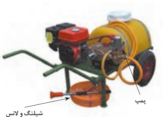
شکل ۲۹-۴. سم‌پاش فرغونی و اجزای آن
