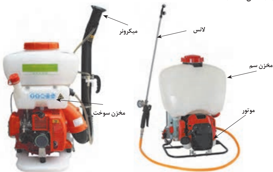
الف- سم‌پاش موتوری لانس دار (پودرپاش) ب- سم‌پاش پشتی اتومايزر (ذره پاش) شکل ۲۸-۴. سم‌پاش‌های پشتی موتوری
