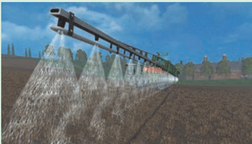
شکل ۴۰-۴. با افزایش ارتفاع میزان همپوشانی و میزان بادبردگی افزایش می یابد.
