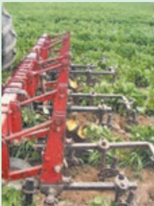
شکل ۱۳-۴. پنجه شاخه ای در حال کار
