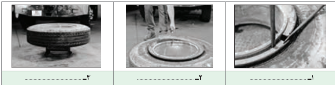
شکل ۲۶-۵- جدا کردن تایر از رینگ دو تکه
