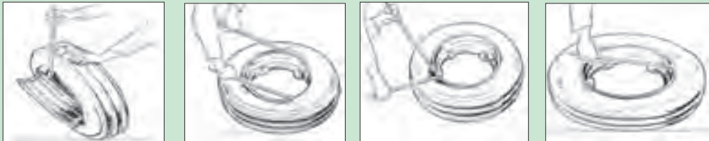
شکل ۲۵-۵- جدا کردن تایر از رینگ یک تکه
