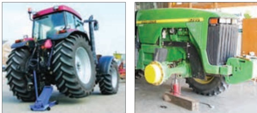
شکل ۲۲-۵- جک زدن زیر تراکتور
