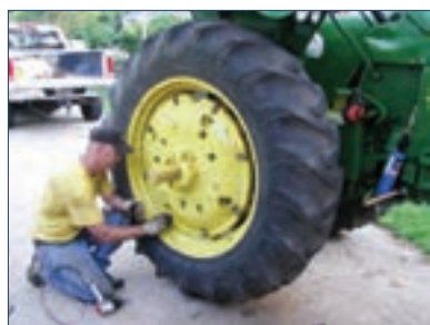
شکل ۲۳-۵- استفاده از دستکش برای باز کردن چرخ
