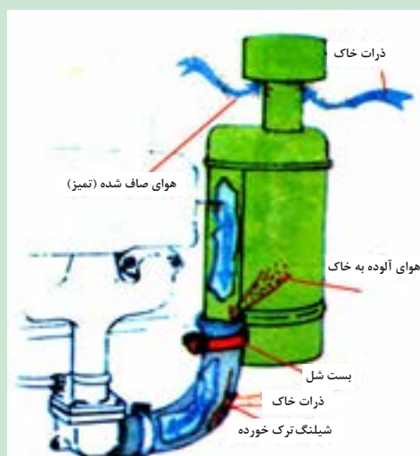
شکل ۶۱-۵- نشستی در شیلنگ های هوا
