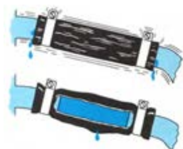
شکل ۵-۵۶- نشستی از شیلنگ ها
