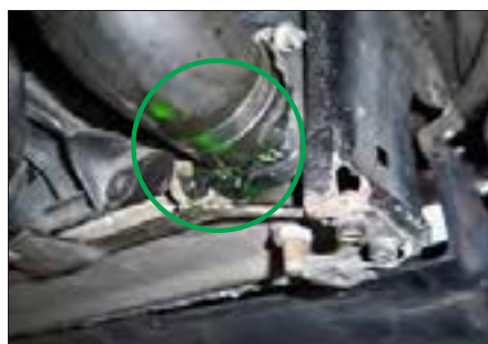
شکل ۵-۵۷- نشست آب از شیلنگ رادیاتور
