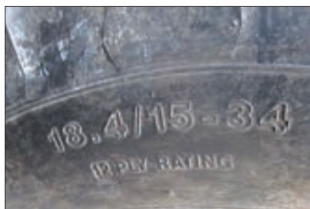
شکل ۱۶-۵- ابعاد تایر تراکتور
