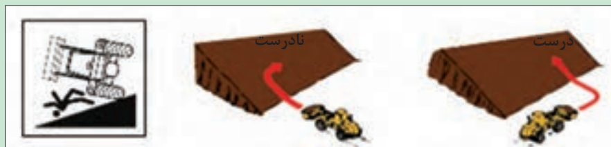
شکل ۴۲-۴- حرکت صحیح روی شیب در جابه‌جایی حمل بار
