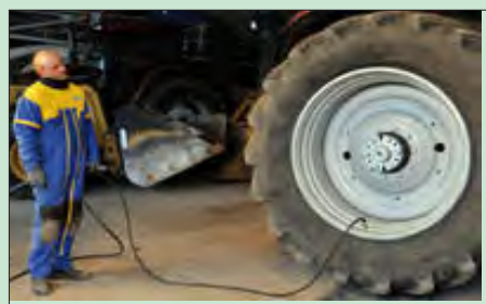
شکل ۳۱-۵- فاصله مناسب را در هنگام باد کردن تایر رعایت کنید.
