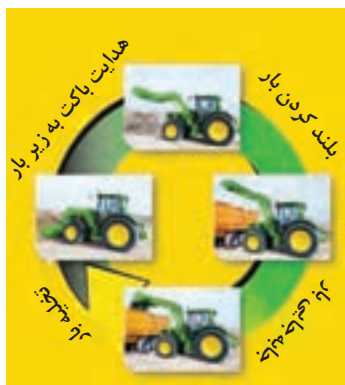
شکل ۳۷-۴ مراحل باربرداری با بیل
