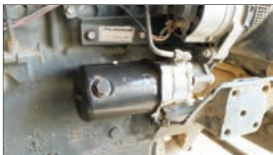
شکل ۴۰-۳- محل بازدید روغن پمپ فرمان تراکتور فرگوسن ۲۸۵
