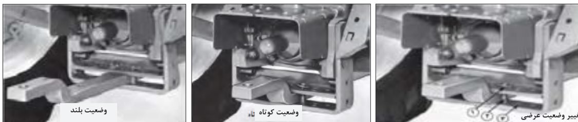
شکل ۵۷-۳- تنظیمات مالبند قابل تنظیم
