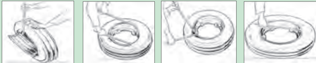
شکل ۲۵-۵- جدا کردن تایر از رینگ یک تکه
