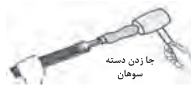
شکل ۴۶-۱- جاذدن و خارج کردن دسته سوهان
