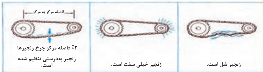
شکل ۱۱-۲- کشش زنجیر
