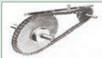
شکل ۱۲-۲- اندازه گیری کشش زنجیر
