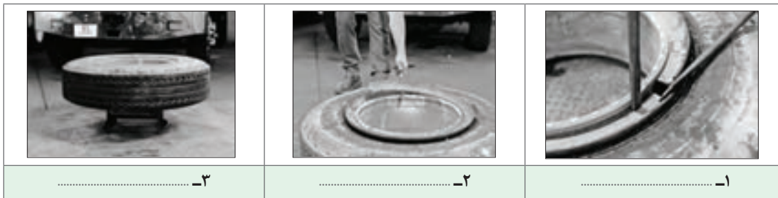
شکل ۲۶-۵- جدا کردن تایر از رینگ دو تکه
