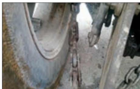
شکل ۷۸-۳- تنظیم زنجیر مهار کننده
