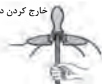
شکل ۴۶-۱- جاذدن و خارج کردن دسته سوهان
