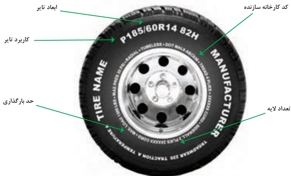
شکل ۱۳-۵- مشخصات فنی و ظاهری تایر
