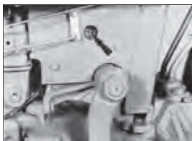
شکل ۳۹-۳- بازدید سطح روغن جعبه فرمان تراکتور ۲۸۵
