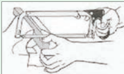
شکل ۱-۴۳- ایجاد شیار راهنما در اره کاری
