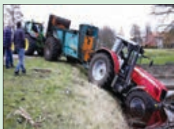
شکل ۳-۲- حوادث ناشی از خرابی سیستم ترمز
