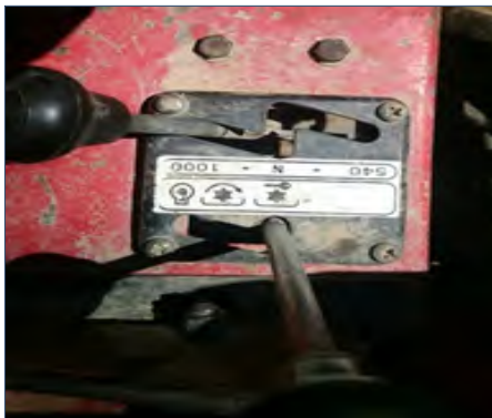
شکل ۷۱-۳- اهرم‌های کنترل محور تواندهی فرگوسن ۳۹۹
