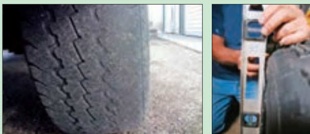
شکل ۴۳-۳- تأثیر تنظیم نبودن زوایای چرخ جلو
