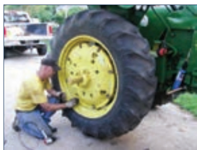
شکل ۲۳-۵- استفاده از دستکش برای باز کردن چرخ
