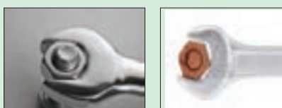
شکل ۹-۱- اندازه مناسب آچار (الف) (ب)
