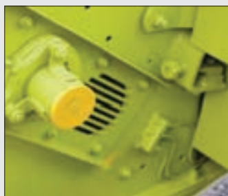
شکل ۴۸- گریس خورهایی که باید بعد از ۲۰ ساعت کار گریس کاری شوند.
