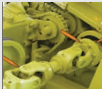
شکل ۴۸- گریس خورهایی که باید بعد از ۲۰ ساعت کار گریس کاری شوند.
