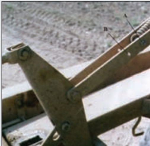
شکل ۳۷- تنظیم فنر شناور
