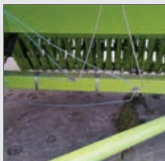
شکل ۹۱- مسیر نخ کردن بسته‌بند و جایگاه سوزن
