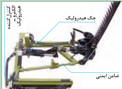
شکل ۱۷- دروگر شانه‌ای با سیستم محرک ارتعاشی
