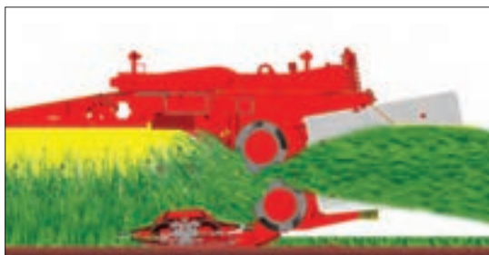
شکل ۵۶- دروساقه کوب و طرز کار آن
