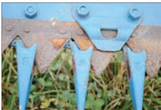
شکل ۱۰- موقعیت انگشتی و تیغه در دروگر شانه‌ای
