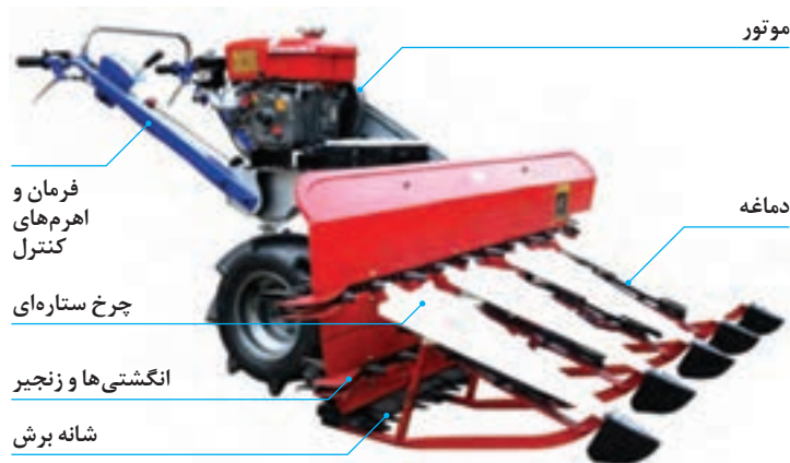
شکل ۱- درو ردیف‌کن و کاربرد آن
