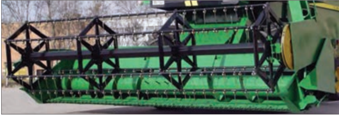
شکل ۱۰- پلاتنفرم مجهز به چرخ و فلک انگشتی‌دار
