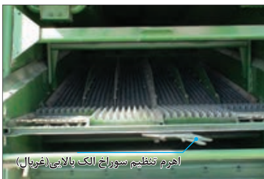
شکل ۲۴- الک بالایی تمیز کننده
