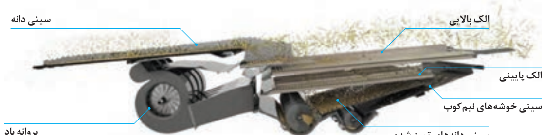
شکل ۲۵- مسیر حرکت محصول درو شده در واحد تمیز کننده
