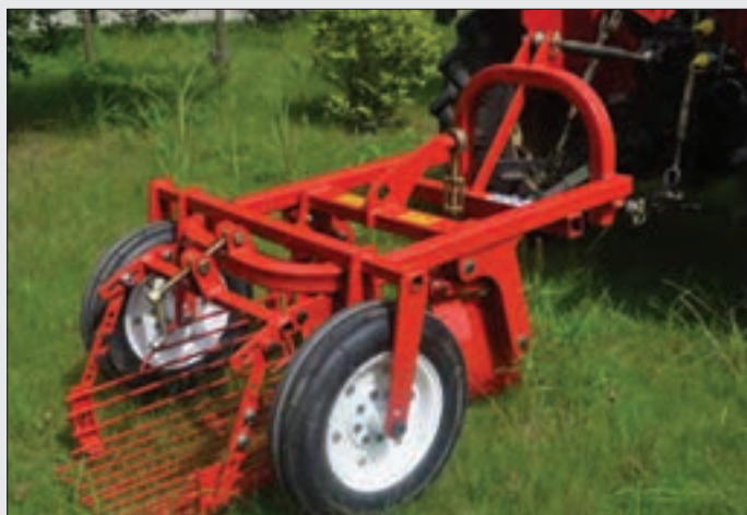
شکل ۱۳- اتصال سیب زمینی کن لرزان به تراکتور
