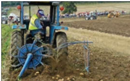
شکل ۹- سیب‌زمینی‌کن دوار در حال کار
