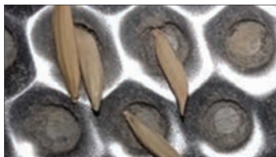
شکل ۱۶- قرار گرفتن دانه‌ها در سوراخ‌های استوانه حفره‌دار
