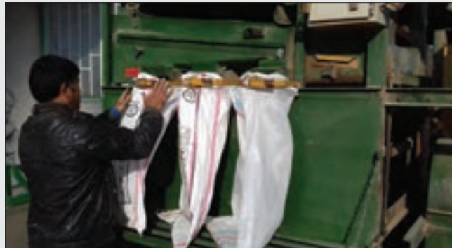
شکل ۳۷- نصب کیسه‌های بارگیری روی کیسه‌بندها
