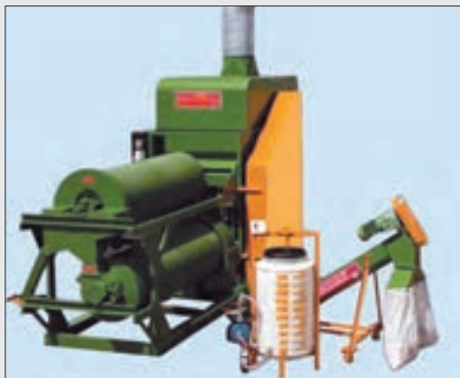
شکل ۲۲- مخزن سم ضد عفونی روی یک ماشین بوجاری
