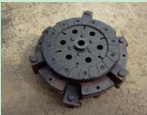
شکل ۲۵. جدا کردن مجموعه کلاچ از فلاپویل
