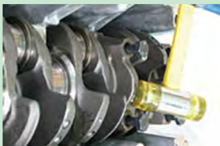
شکل ۴۷. شل کردن کپه‌های یاتاقان
