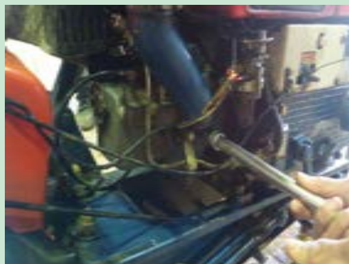
شکل ۵۲. باز کردن مانیفولد هوا
