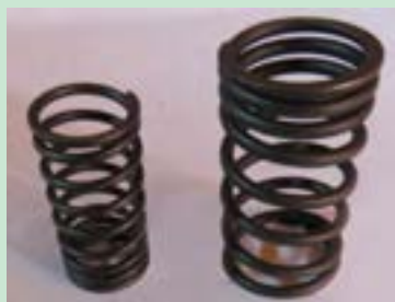
شکل ۱۸. فنرهای سوپاپ در تراکتور MF۲۸۵
