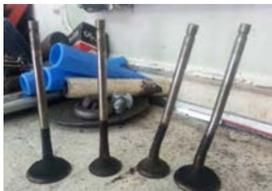
شکل ۶۷. کربن گرفتگی سرسیلندر و سوپاپ‌ها
