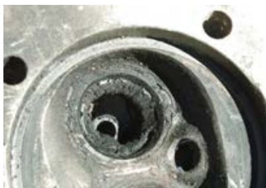
شکل ۶۷. کربن گرفتگی سرسیلندر و سوپاپ‌ها
