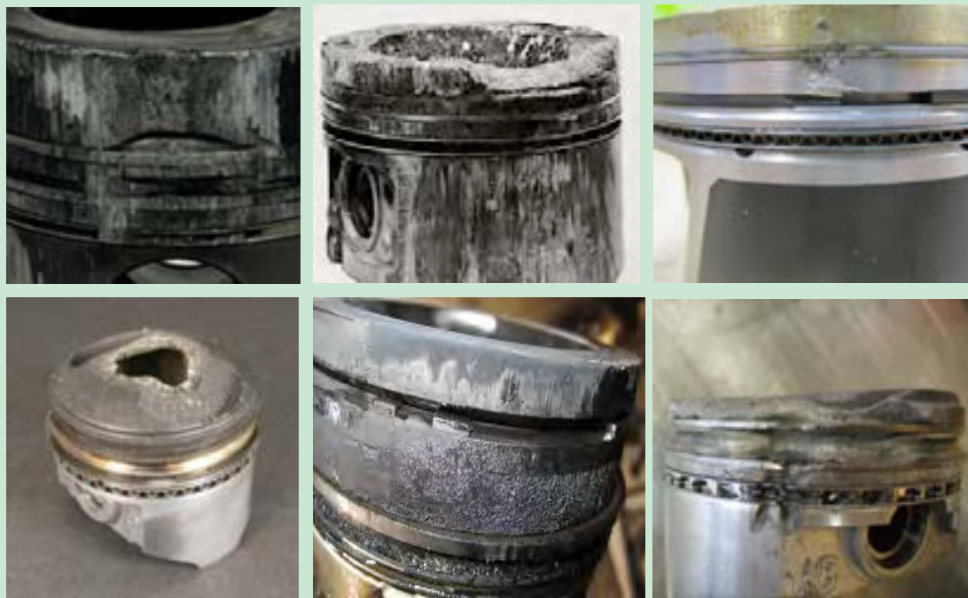
شکل ۷۴. نمونه ای از پیستون های معیوب
