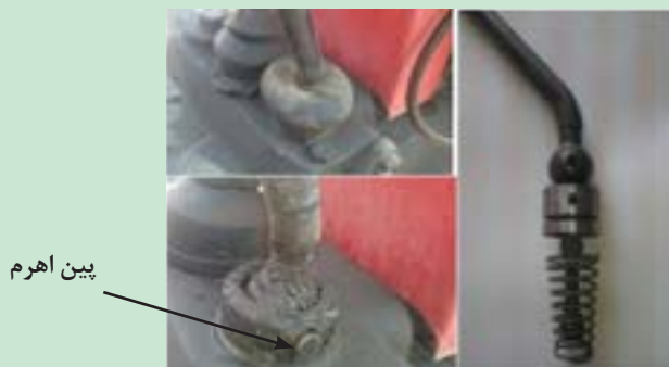
شکل ۲۹. خارج کردن اهرم‌های تعویض دنده
