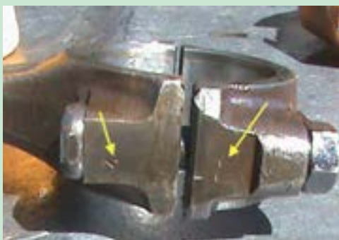
شکل ۴۴. هم علامت بودن شاتون و کپه شاتون ۱۱- پیستون و شاتون‌های سیلندرهای دیگر را هم به همین ترتیب خارج کرده روی میز بچینید.
