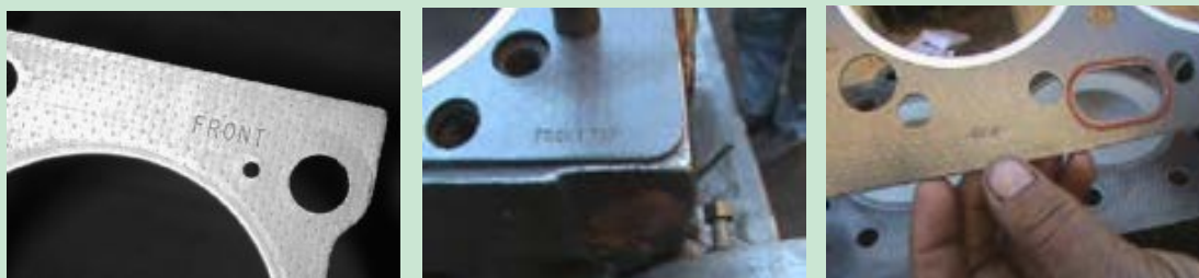
شکل ۸۶. علامت‌های روی واشر سرسیلندر
