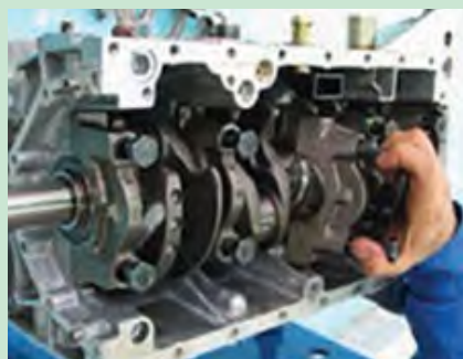
شکل ۴۸. برداشتن کپه‌های یاتاقان و چیدن آنها
