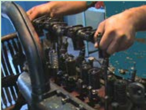
شکل ۴۶. برداشتن مجموعه اسبک از روی سرسیلندر
