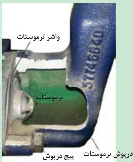
شکل ۱۷. نمای برش خورده ترموستات تراکتور MF285
