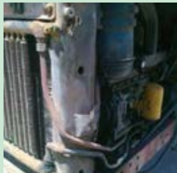
شکل ۱۳. رادیاتور روغن تراکتور U650
