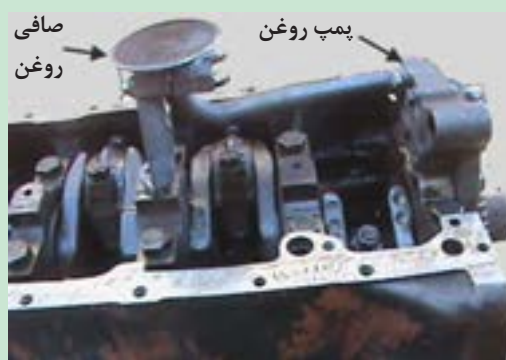
الف- محل پیچ‌های اتصال پمپ روغن به بلوکه سیلندر
