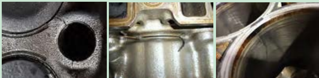
شکل ۶۲. ترک در سیلندر و بلوکه سیلندر
