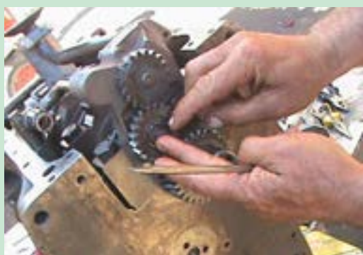
ب- چرخ دنده‌های محرک پمپ روغن
