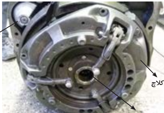
محل سوار شدن شفت ورودی جعبه دنده
