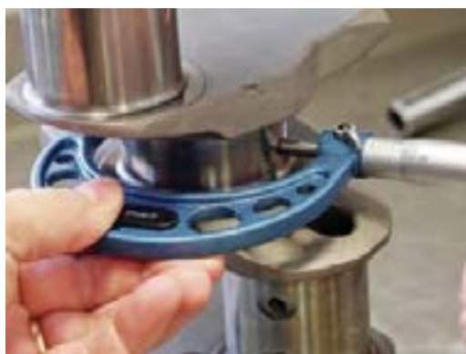
شکل ۷۱. اندازه گیری قطر میل لنگ
