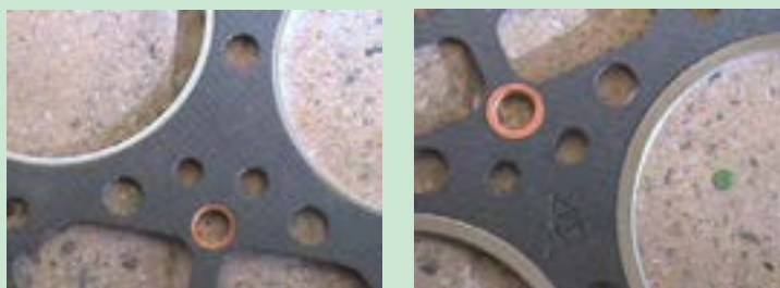
شکل ۸۷. تفاوت ضخامت قسمت‌های مسی روی واشر سرسیلندر
