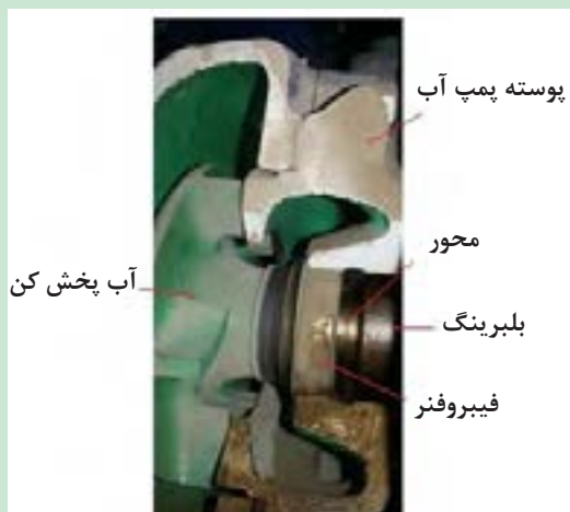
شکل ۱۶. مهره پایه پروانه و نمای برش خورده پمپ آب تراکتور MF285
