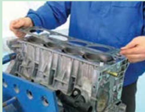
شکل ۵۰. برداشتن واشر سرسیلندر
