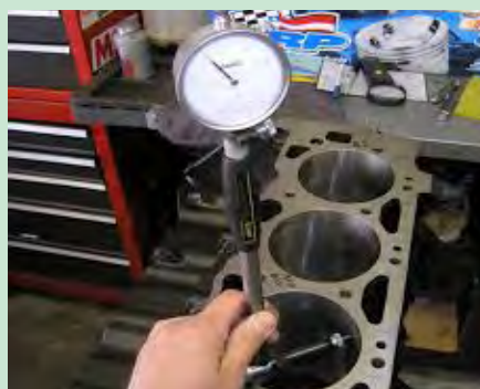
شکل ۷۶. اندازه‌گیری قطر سیلندر با میکرومتر داخلی
