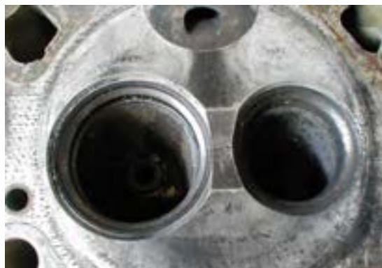
شکل ۶۶. ترک خوردگی سرسیلندر در محفظه احتراق
