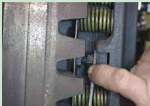
شکل ۳۹. تنظیم کلاچ محور تواندهی
