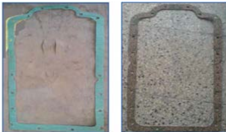
الف - واشر کارتر چوب پنبه‌ای MF285 ب - واشر کارتر ویکتوری MF285 شکل ۴۷. واشر کارتر
