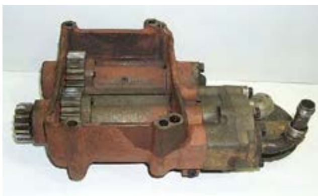
شکل ۴۴. بالانس‌های نصب شده روی پمپ روغن
