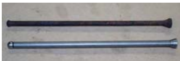
شکل ۷۶. زنگ زدن و شکستگی میل تپت
