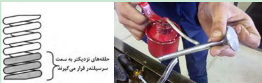
شکل ۸۵. جهت نصب فنر سوپاپ
