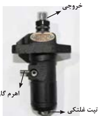
شکل ۲۷. پمپ انژکتور واحدی و موقعیت آن روی تراکتور باغی با موتور لمباردینی
