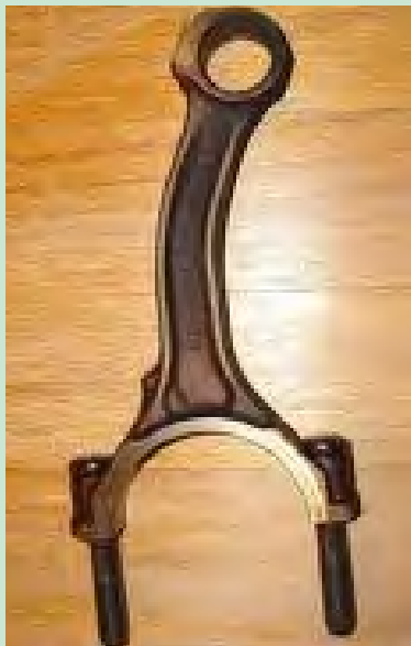
شکل ۸۲. پیچیدگی شاتون، اندازه گیری و اصلاح آن
