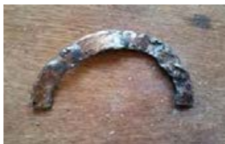
شکل ۷۳. نمونه بغل یاتاقانی معیوب
