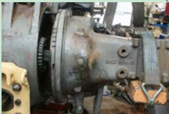
شکل ۷. باز کردن پوسته قیفی تراکتور MF285
