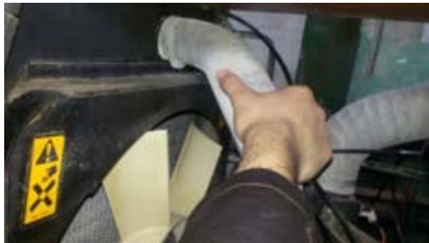
شکل ۹. آزمایش صحت باز شدن مدار خنک کننده توسط ترموستات
