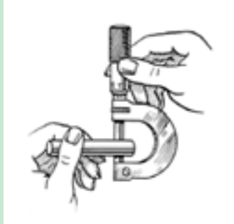
شکل ۸۱. اندازه گیری لقی گژن بین در پیستون
