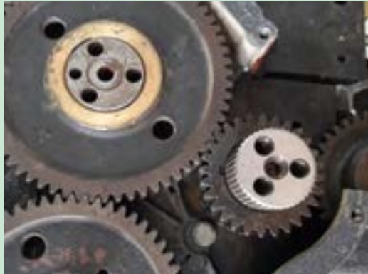
شکل ۱۰۹. علامت‌های تایمینگ روی چرخ دنده ها
