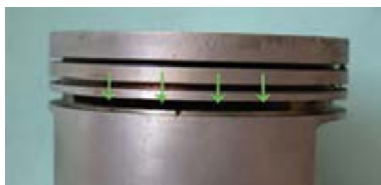
شکل ۹. ترتیب قرار گرفتن رینگها و موقعیت شیاری عرضی پیستون زیر ناحیه قرار گرفتن رینگ روغنی
