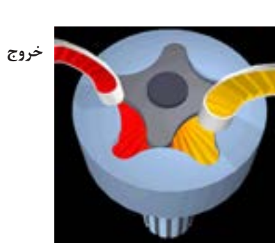
شکل ۴۳. پمپ روغن روتوری
