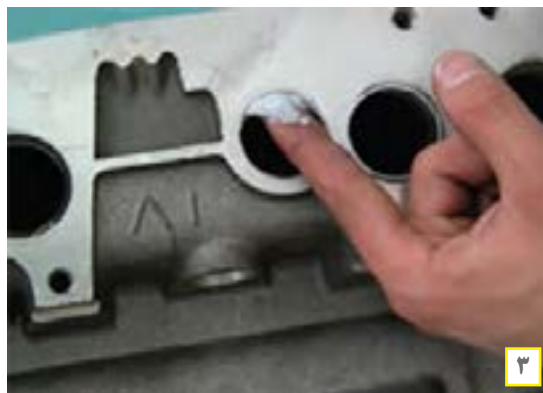
شکل ۶۹. روش تعویض پولک سر سیلندر
