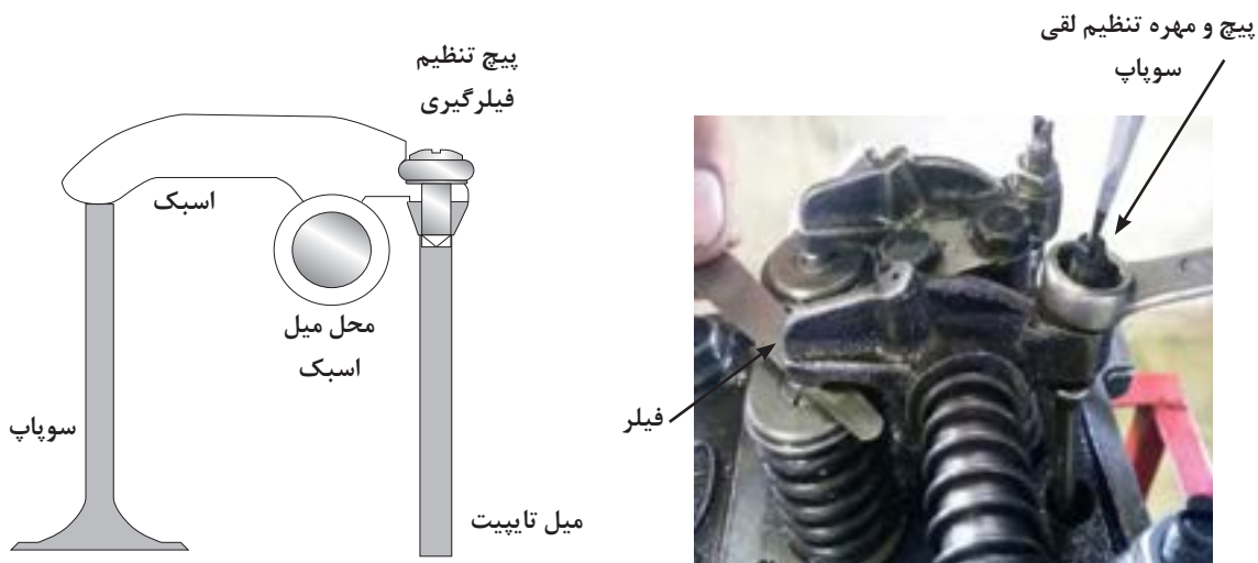
شکل ۳۲. پیچ و مهره تنظیم لقی سوپاپ
