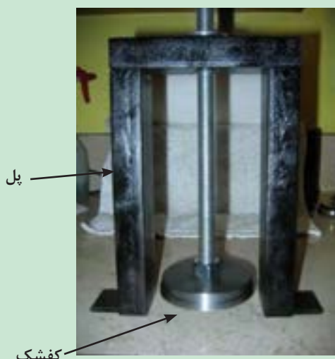
شکل ۵۵. خارج کردن بوش پیستون از بلوکه سیلندر با ابزار بوش کش
