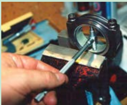
شکل ۸۳. کنترل بیضی شدن سر بزرگ شاتون
