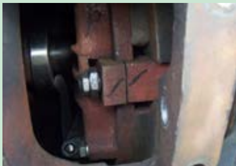
شکل ۲۶. علامتگذاری قطعات مجموعه کلاچ
