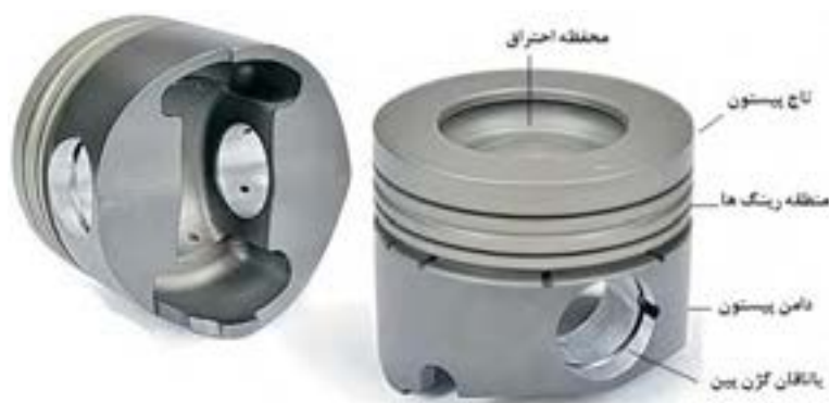
شکل ۶. پیستون و قسمت های مختلف آن
