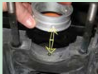
شکل ۹۳. قرار گرفتن سوراخ روغن مقابل هم
