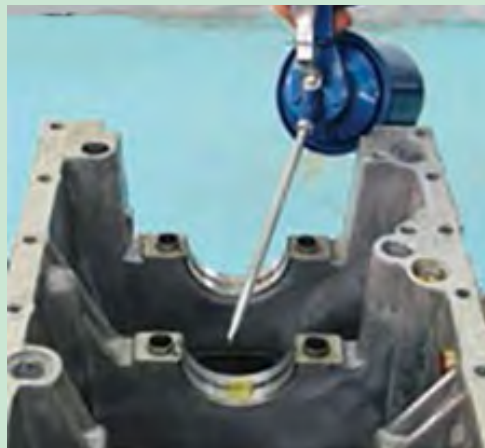
شکل ۹۵. روغنکاری یاتاقان ها قبل از نصب
