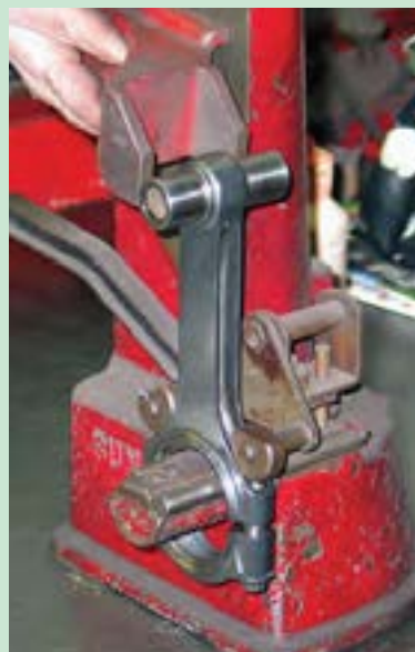
شکل ۸۲. پیچیدگی شاتون، اندازه گیری و اصلاح آن
