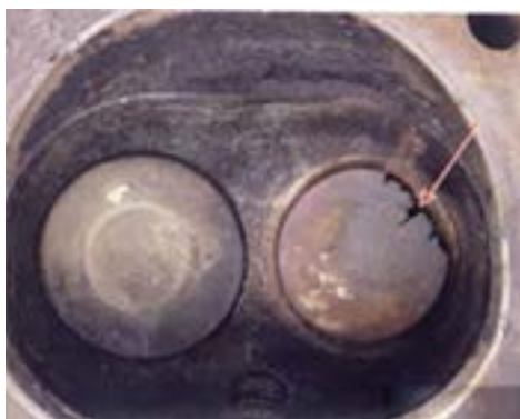
شکل ۷۰. عیوب ظاهری سوپاپ‌ها
