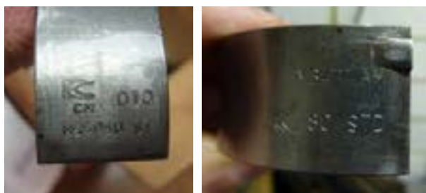
شکل ۲۳. تغییر ضخامت یاتاقان در سایزهای مختلف
