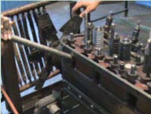
شکل ۴۹. آزاد کردن چسبیدگی سرسیلندر
