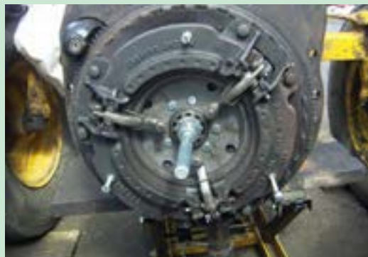
شکل ۳۷. سوار کردن مجموعه کلاچ روی فلاپویل
