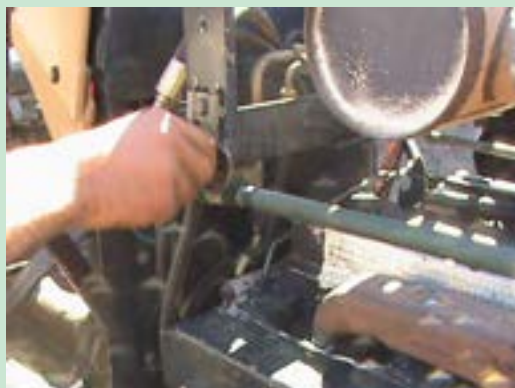
شکل ۴۱- باز کردن انباره اگزوز تراکتور MF۳۹۹
