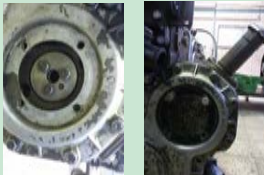
شکل ۳۲. پیچ های درپوش زمان بندی و چرخنده پمپ انژکتور تراکتور MF۲۸۵
