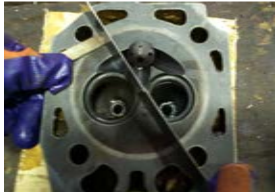
شکل ۶۵. کنترل تابیدگی سرسیلندر تراکتور دوچرخ
