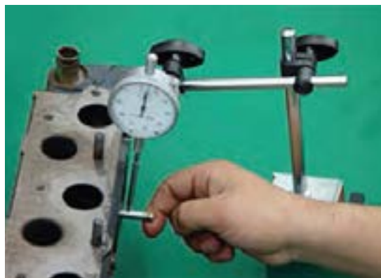
شکل ۷۳. روش کنترل لقی بین سوپاپ و گیت
