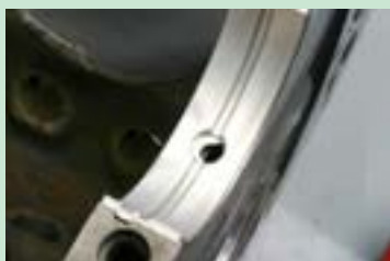
شکل ۹۳. قرار گرفتن سوراخ روغن مقابل هم
