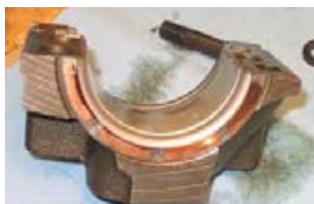
شکل ۷۳. نمونه بغل یاتاقانی معیوب
