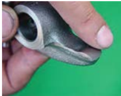
شکل ۷۵. فرسودگی سر اسبک
