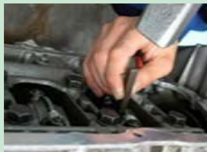
شکل ۴۱. علامت زدن کپه شاتون
