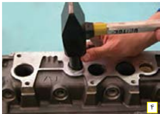
شکل ۶۹. روش تعویض پولک سر سیلندر
