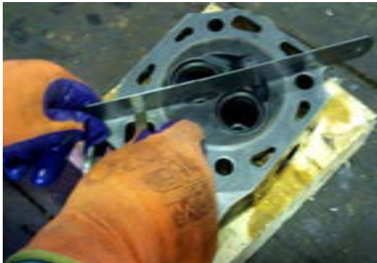
شکل ۶۵. کنترل تابیدگی سرسیلندر تراکتور دوچرخ
