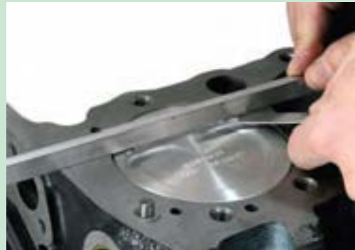
شکل ۱۰۳. کنترل سطح پیستون نسبت به سطح بلوکه سیلندر با فیلهر و ساعت اندازه گیری
