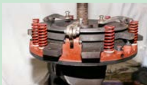
شکل ۲۸. قرار دادن مجموعه کلاچ روی گیره جهت تفکیک قطعات
