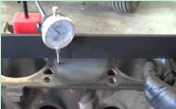
شکل ۱۰۳. کنترل سطح پیستون نسبت به سطح بلوکه سیلندر با فیلهر و ساعت اندازه گیری
