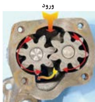
شکل ۴۲. پمپ روغن دنده ای
