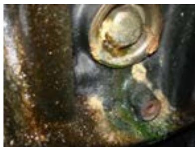
شکل ۷. نشتی از پولکی‌های موتور
