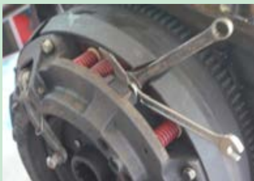
شکل ۳۹. تنظیم کلاچ محور تواندهی
