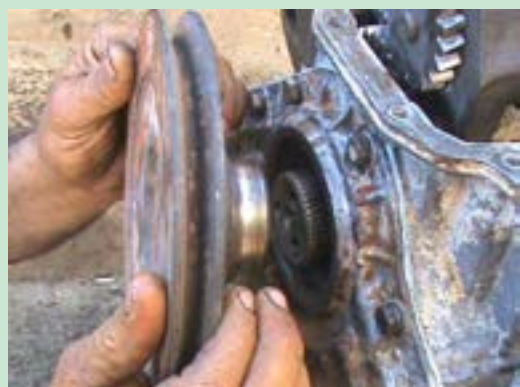
شکل ۱۱۲. جا زدن پولی سر میل لنگ
