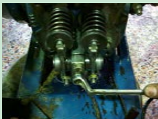
شکل ۵۴. باز کردن مجموعه اسبکها
