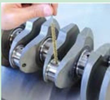
شکل ۶۰. تمیز کردن مجاری میل لنگ
