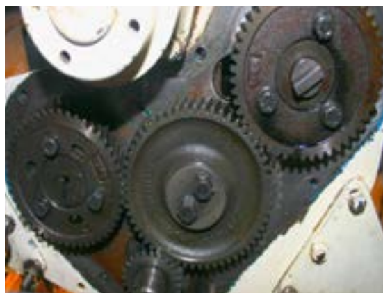
شکل ۲۷. چرخ دنده‌های تایمینگ در سینی جلو موتور
