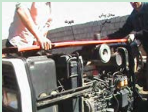
شکل ۴۰. برداشتن کاپوت تراکتور MF۳۹۹
