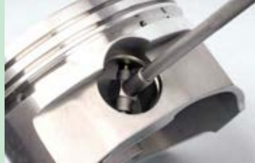
شکل ۸۱. اندازه گیری لقی گژن بین در پیستون
