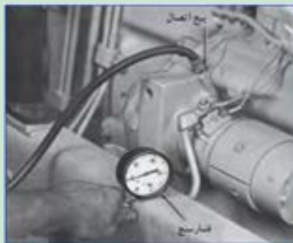
شکل ۵۰. فشار سنجی مدار روغن کاری
