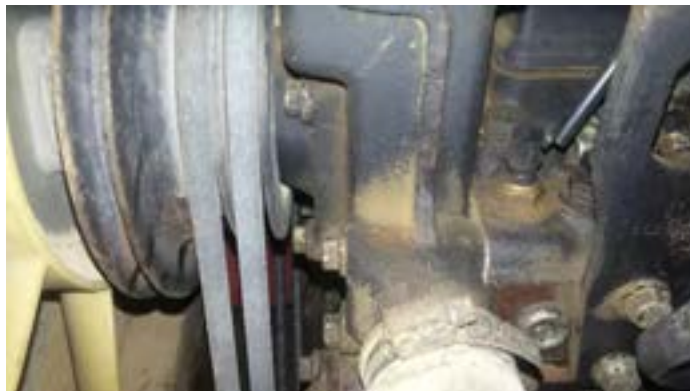
شکل ۱۰. محل فشنگی آب روی تراکتور MF399
