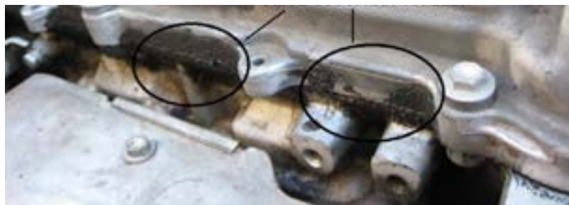
شکل ۲۷. نشستی روغن از درپوش سوپاپ‌ها
