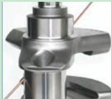
شکل ۶۰. تمیز کردن مجاری میل لنگ
