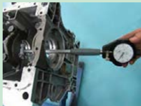
شکل ۶۳. کنترل دو پهنی تکیه‌گاه‌های میل‌لنگ
