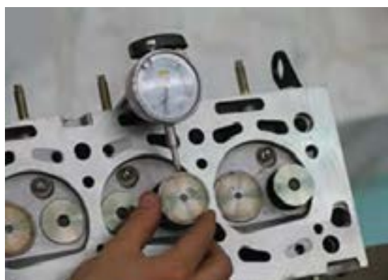
شکل ۷۳. روش کنترل لقی بین سوپاپ و گیت
