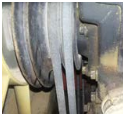
شکل ۷. استفاده از دو تسمه در تراکتور MF۳۹۹
