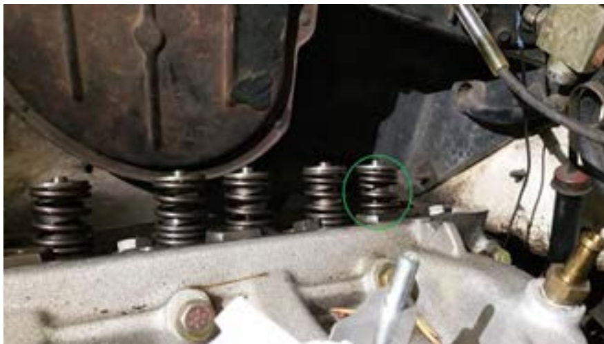
شکل ۷۱. شکستن فنر سوپاپ
