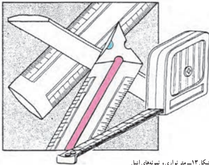
شکل ۱۳- متر نواری و نمونه‌های اشل
