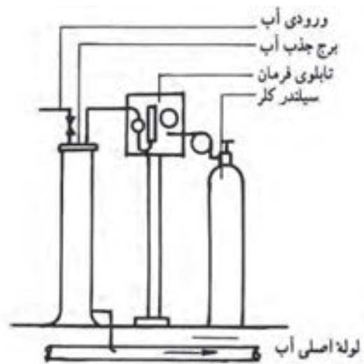
▲ شکل ۴-۶- نمای ساده دستگاه کلرزنی
