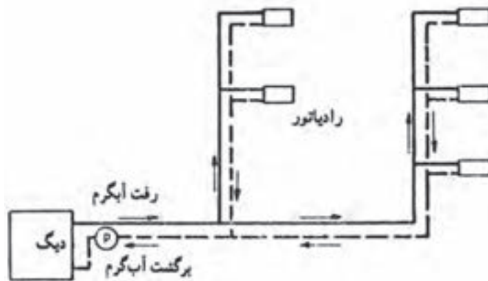
▲ شکل ۳-۹- حرارت مرکزی با آب گرم
