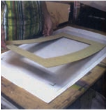
۴- با استفاده از یک قاب مقوایی می‌توانید قطعات مرکبی شده را به درستی در جای خود قرار دهید.
