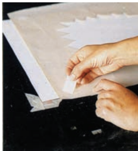
تصویر ۱۲۳- تنظیم کاغذ چاپ و استنسیل آماده شده برای مرحله چاپ
