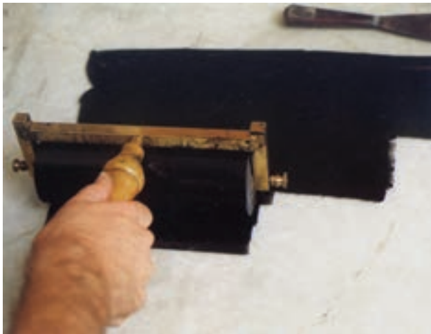
تصویر ۶۰- پخش کردن مرکب روی سطح شیشه
